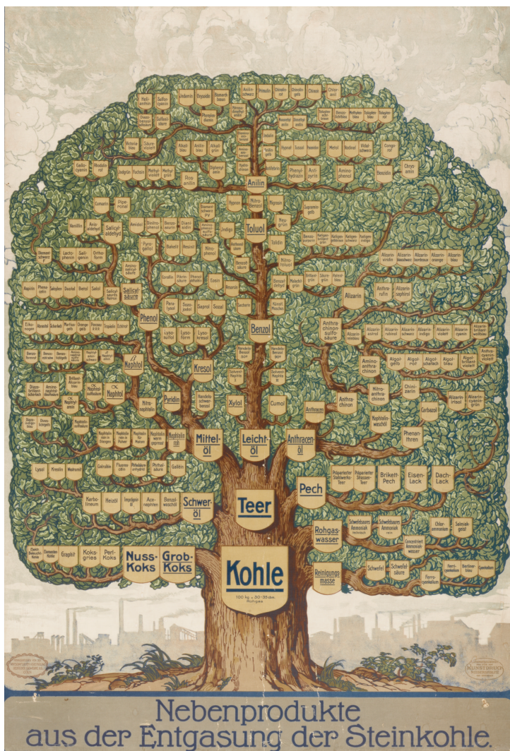
Abb. 12: Der „Teerbaum“ mit den wichtigsten kohlechemischen Produkten 159
