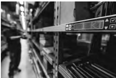
Bild 17-18: Arbeitsplatz Kleinteilekommissionierung mit Pick by light-Kennzeichnung
