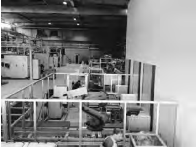
Bild 3: Kardex Remstar LR 35 mit Roboter- und Fördertechnikanbindung als Produktionspuffer
