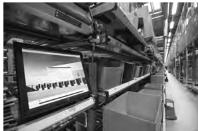
Bild 17-18: Arbeitsplatz Kleinteilekommissionierung mit Pick by light-Kennzeichnung
