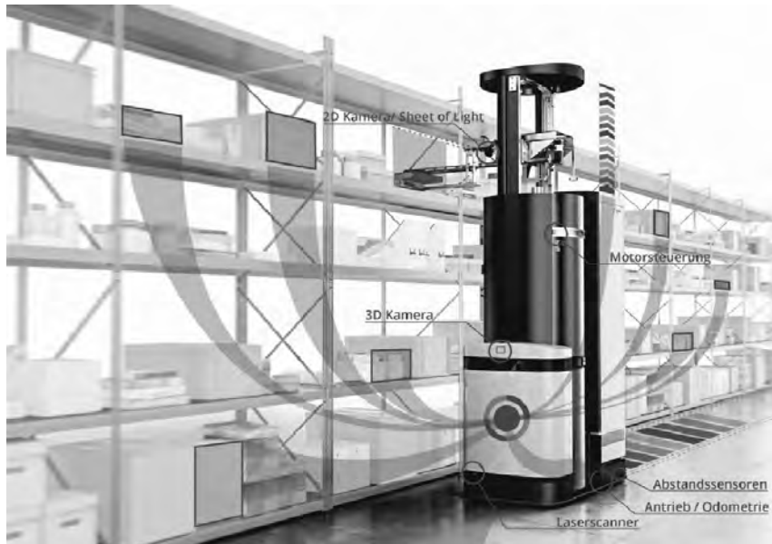
Bild 1: Der mobile Roboter TORU Cube generiert mit seinen Sensoren rund 2GB Daten pro Minute.
