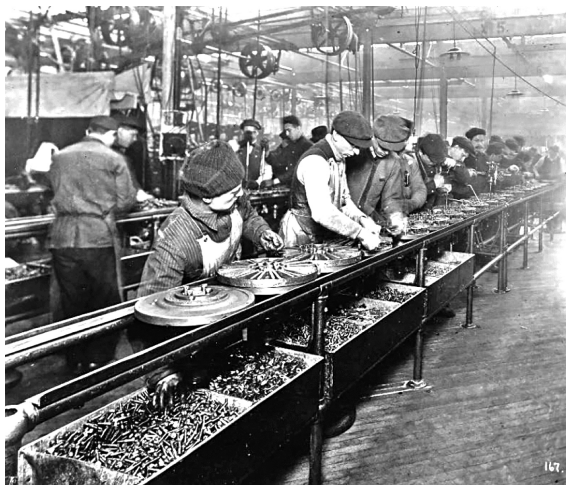
Abbildung 9: „Flywheel Magneto“-Montagelinie, Highland Park (1913)
