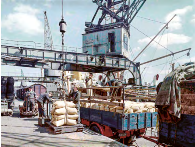
Abb. 1: Güterumschlag mit Halbportalkran im Freihafen, Hamburg, Foto 1957.
