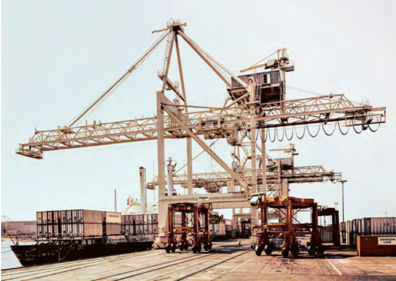
Abb. 4: Burchardkai, Hamburg-Waltershof, Containerbrücke mit Van Carriern, Foto 1970.
