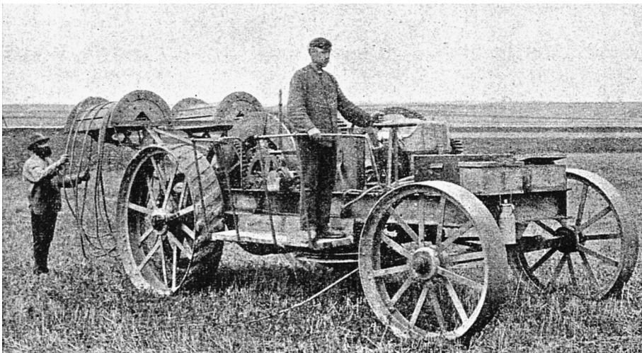
Abb. 3: Elektropflug-Motorwagen eines nicht genannten Herstellers. Quelle: A. Vietze, Die Elektrizität in der Landwirtschaft, Halle/S. 1911, S. 37.
