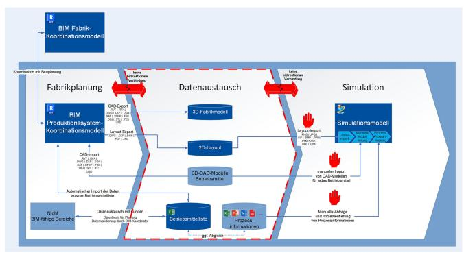
Bild 2. Stand der Technik - Beispielhafte Anbindung von BIM und Simulation. Grafik: Ingenics Consulting
