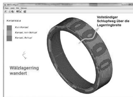
Bild 10: Beispielhaftes Ergebnis SimWag2.1 288 , Wälzlagererring wandert [6]
