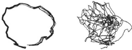
Bild 1: Gemessener stabiler und instabiler Käfigorbit eines Schrägkugellagers [11]
