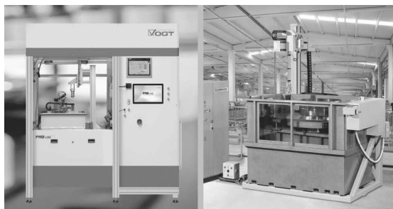
Bild 04: Ultraschallprüfsysteme für die fertigungsbegleitende und wiederkehrende Wälzlagerprüfung. links: VOGT PROline CUSTOM für die autom. Inlineprüfung kleiner Lagerringe; rechts: LS 200 ScanMaster universal Prüfsystem für große Lagerringe
