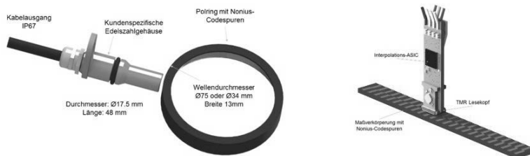
Bild 5: TMR Winkel- und Drehzahlsensor für radiale Abtastung (Quelle: NTN-SNR Bearings)
