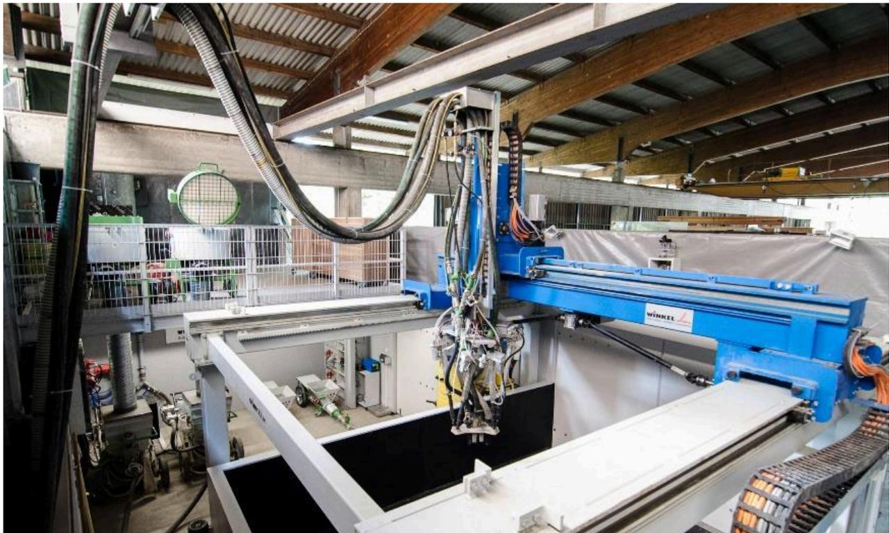
Abb. 64: Applikationssystem mit Stewart-Gough-Plattform © ILEK<sup>528</sup>
