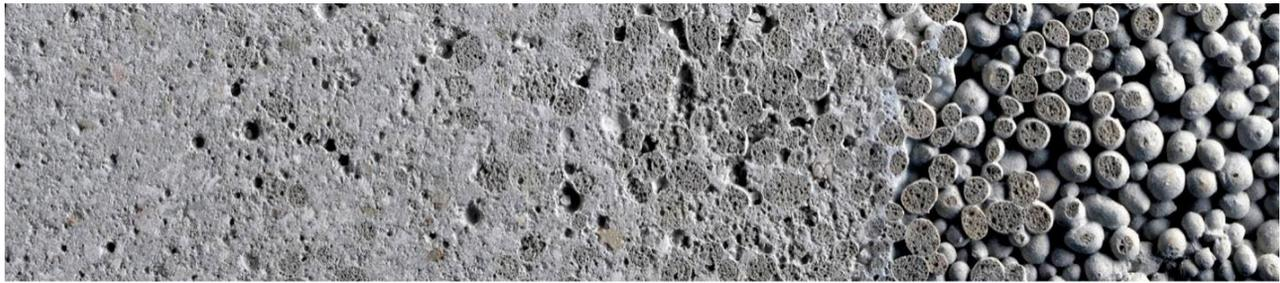
Abb. 60: Geschichteter Porositätsgradient<sup>516</sup> © Institut für Leichtbau Entwerfen und Konstruieren (ILEK), Universität Stuttgart
