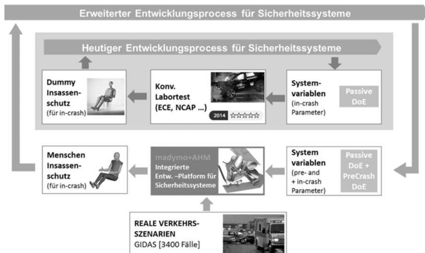
Bild 1: Integrierte Sicherheitsmethodik: Entwicklung & Testschleifen zur Erprobung des Nutzens für menschliche Insassen bei Unfällen im wirklichen Leben
