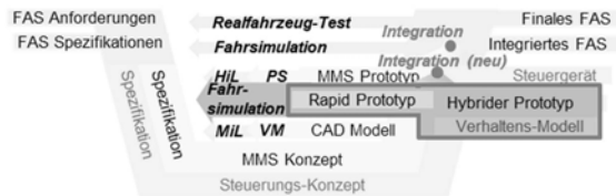
Bild 2: V-Modell der Entwicklung und Absicherung mit dem SHPiL Ansatz
