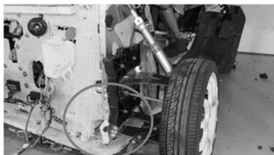
Bild 7: Bruch der Sandwichpaneele am strukturell wichtigen Übergang zwischen Seiten-, Boden- und Spritzwandpaneel an der unteren A-Säule
