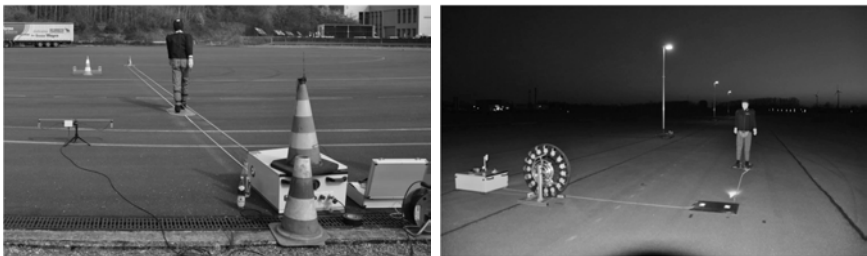
Bild 5: 4a Surfboard ( www.4activesystems.at/en/ ) als Beispiel für eine Bewegungsanlage, Aufbau mit doppeltem (links) und einzeltem (rechts) Riemen
