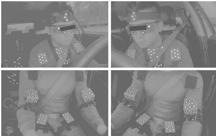
Bild 1: Bewegungserfassung am Probanden
