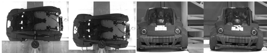
Bild 14: Der Pfahl dringt nicht in die Fahrgastzelle ein und die Batterien bleiben geschützt, jeweils bei t=0 ms und t=67 ms (max. Pfahlintrusion)
