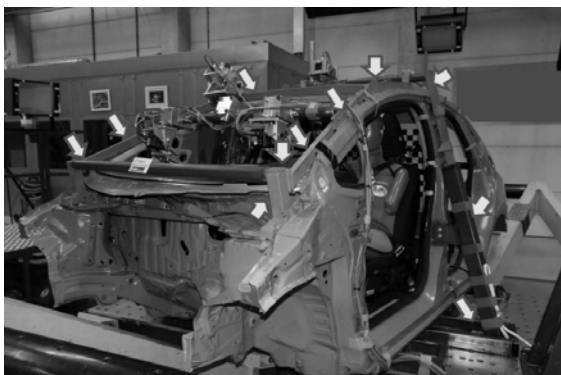
Bild 6: Karosseriebefestigung und -versteifung [10]
