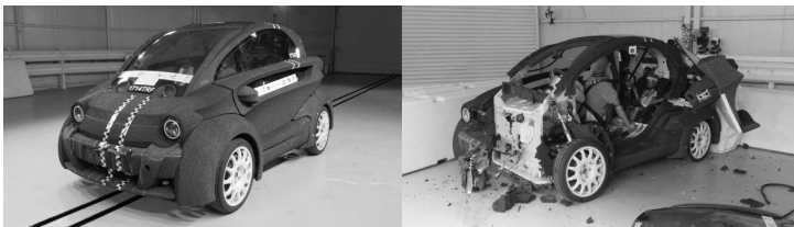
Bild 5: BEHICLE vor und nach dem Euro NCAP ODB-Crashtest
