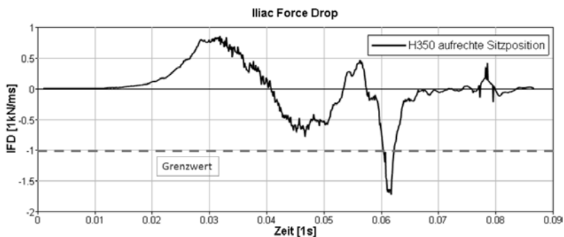
Bild 2: IFD-Verlauf mit Submarining am Bsp. H350, IATmbH, 2017.
