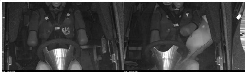
Bild 10: 4-Punktgurt und voluminöse Seiten- und Curtainairbags überbrücken den großen Abstand zwischen Insassen und Tür durch die zentrale Sitzposition (links t=0 ms, rechts t=50 ms)
