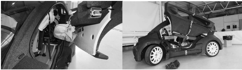
Bild 11: Durch die geringe bleibende Deformation ist die stoßzuggewandte Tür ohne zusätzlichen Kraftaufwand zu öffnen
