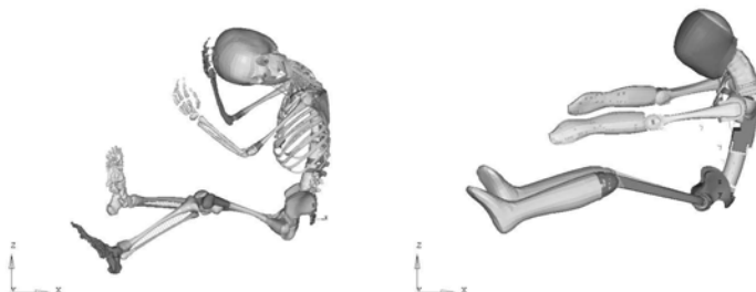
Bild 4: Rotation des Kopfes ist bei dem Menschmodell nach dem Kopfaufprall größer als bei dem Q6 Dummy in der ersten Unfallrekonstruktion
