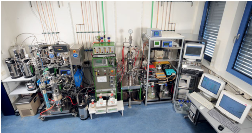
Bild 3.1: Forschungsbioreaktor BIostat ED5 mit Peripherie und EBA-Chromatographie
