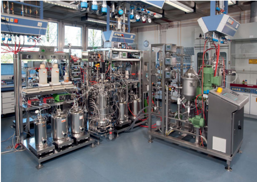
Bild 6.2: Scale-down Forschungsanlage zur Herstellung rekombinanter Proteine
