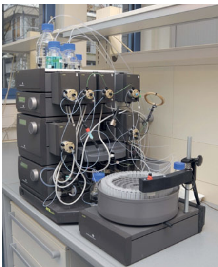
Bild 3.13: ÄKTA™purifier 100 zur Feinreinigung des Zielproduktes
