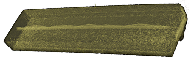
Bild 3. Beispielhafter CT-Scan einer Probe. Gelb markiert sind Poren und unversinterter Pulver. Deutlich zu sehen ist der Bereich unversinterter Pulvers entlang des Roving. Grafik: KIT/wbk
