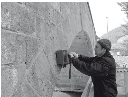
Abb. 1 Sensor an einem Brückenbogen
