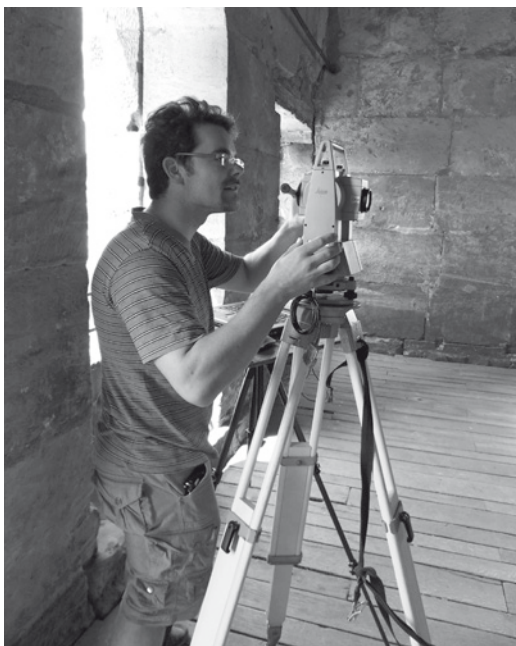
Abb. 5 Tachymetervermessung in der Porta Nigra in Trier
