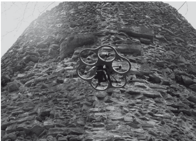
Abb. 11 Drohne als Kameraträger am Drususstein in Mainz
