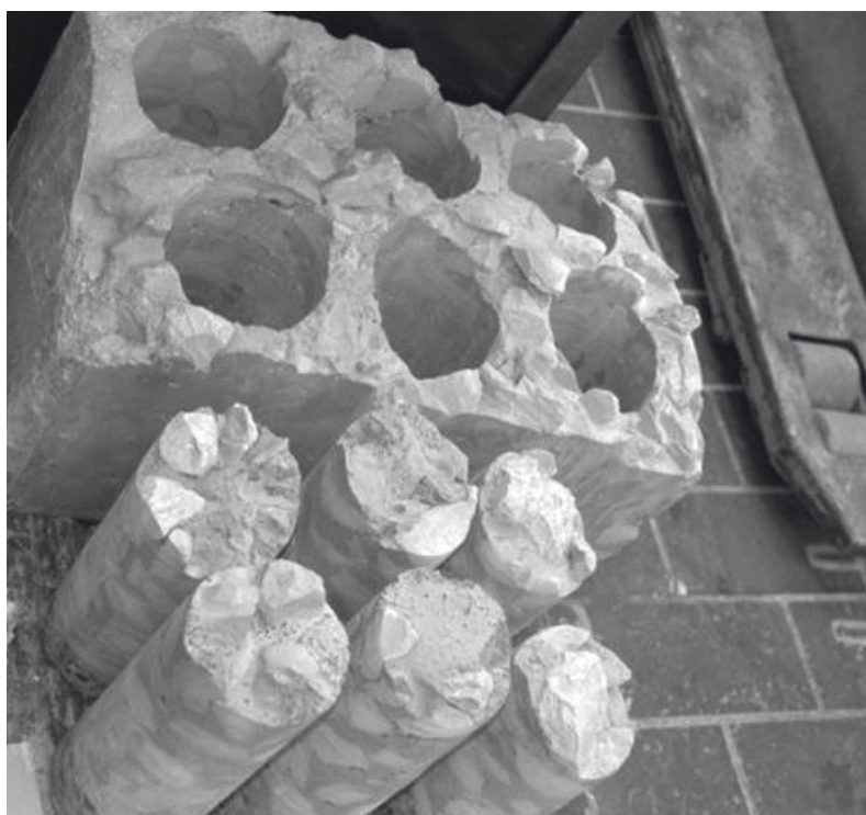
Abb.11 Vorversuche zur Hohlraumausfüllung mit Injektionsmörtel in Bruchsteinmauerwerk
