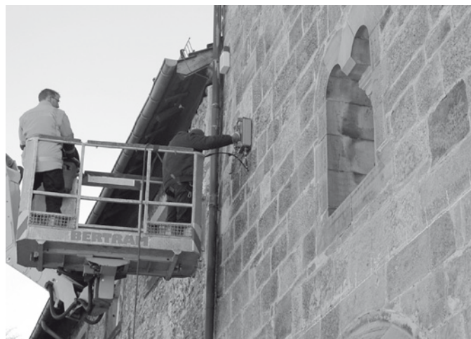
Abb. 4 900 MHz Sensor für die Untersuchungen zum Wandaufbau
