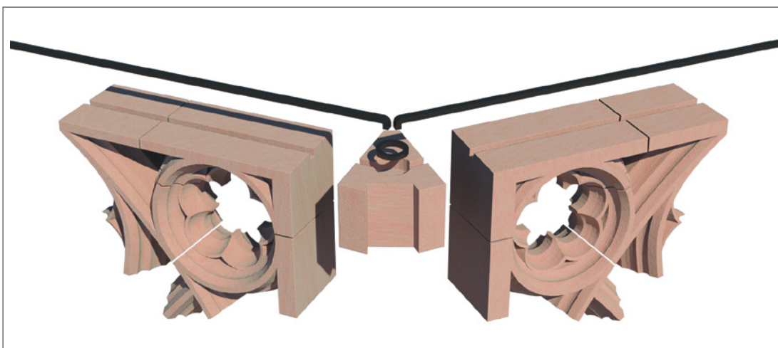
Bild 8 3-D-Darstellung von Ringanker, Eckstein und Maßwerksteinen
