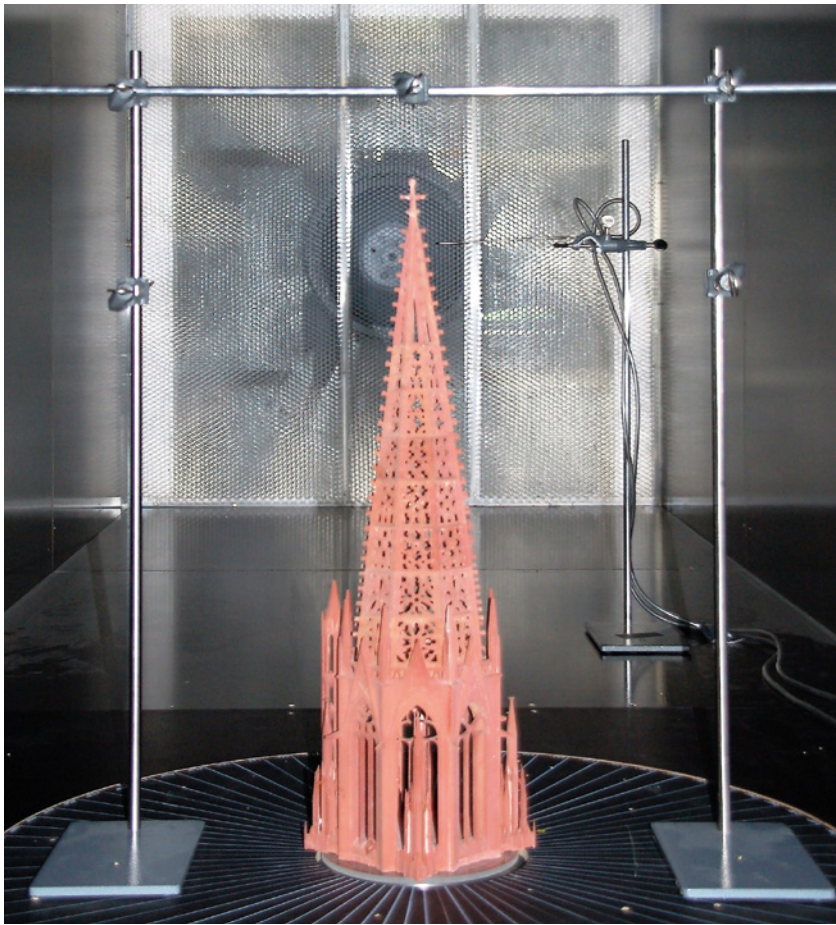
Bild 12 Turmmodell im Windkanal
