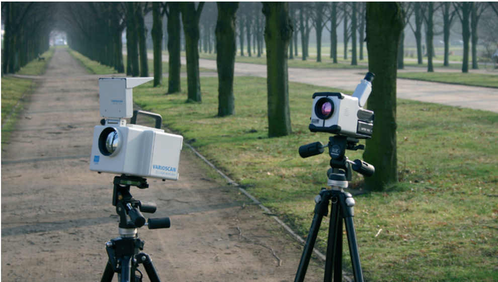
Abbildung 3-9 Thermografiekameras bei einer Vergleichsmessung (links: mit Stirling-Kühler ausgerüstete, scannende Einelemente-Kamera, rechts: ungekühlte Micro-Bolometerkamera, jeweils 320 \times 240 Pixel)
