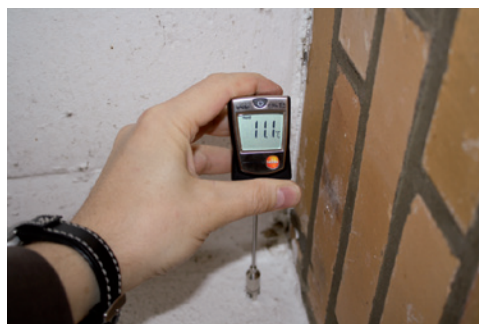
Abbildung 5-15 Außenansicht des Gebäudes, Bestimmung der Oberflächentemperatur in der einspringenden Decke (linke Seite des Balkons im 1.OG) mit Hilfe eines Kontaktoberflächenthermometers, angezeigter Messwert: \theta_s = 11,1 \text{ }^\circ\text{C}
