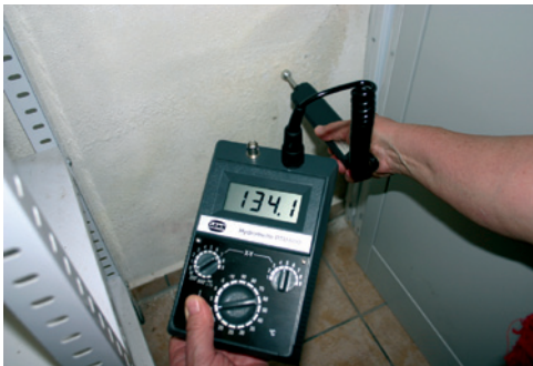
Abbildung 7-38 Messung der Feuchte, im unteren Wandbereich ca. 134 digits, im oberen Wandbereich ca. 107 digits
