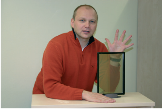
Abbildung 2-16 Normales Fensterglas ist für langwellige Wärmestrahlung kaum durchlässig.
