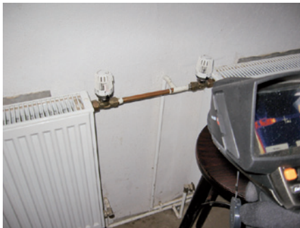
Abbildung 2-10 Thermogramm einer Heizungsleitung. Unter Ansatz eines globalen Emissionsgrades wird die Temperatur am Rohr mit real unterschiedlichen Emissionsgraden (blank und weiß gestrichen) nicht richtig wiedergegeben.
