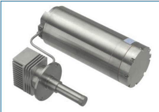
Abbildung 3-3 Stirling-Kühler – linearangeordnete, gesplittete Ausführung (Quelle: Fa. AIM GmbH, Heilbronn 2003), 1,5 Watt Kälteleistung (links: cold tip = kalter Finger, \varnothing 13,7\text{ mm} )
