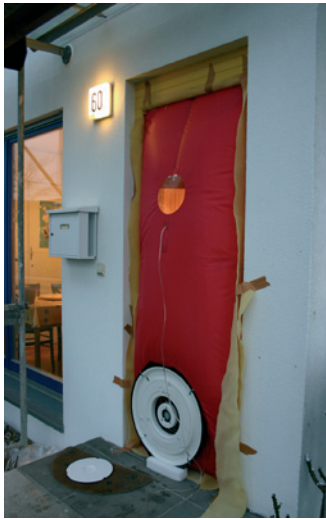
Abbildung 7-27 Blower-Door im eingebauten Zustand (Überdruckprüfung)
