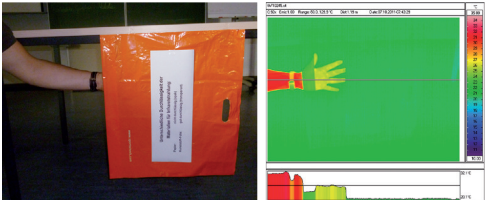
Abbildung 2-18 Kunststofffolien sind gegenüber Infrarotstrahlung sehr transparent, für sichtbare Wellenlängen sind sie hingegen nicht durchlässig.
