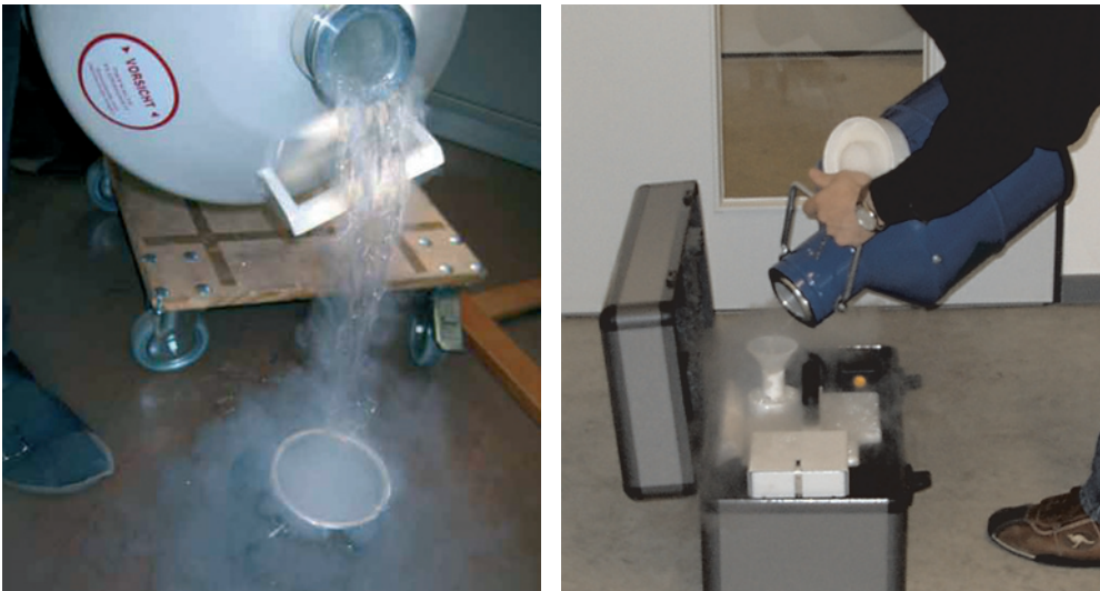
Abbildung 3-2 Stickstoffkühlung – Abfüllen vom Lagertank und Befüllung einer Thermografiekamera mit flüssigem Stickstoff
