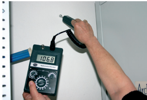
Abbildung 7-38 Messung der Feuchte, im unteren Wandbereich ca. 134 digits, im oberen Wandbereich ca. 107 digits
