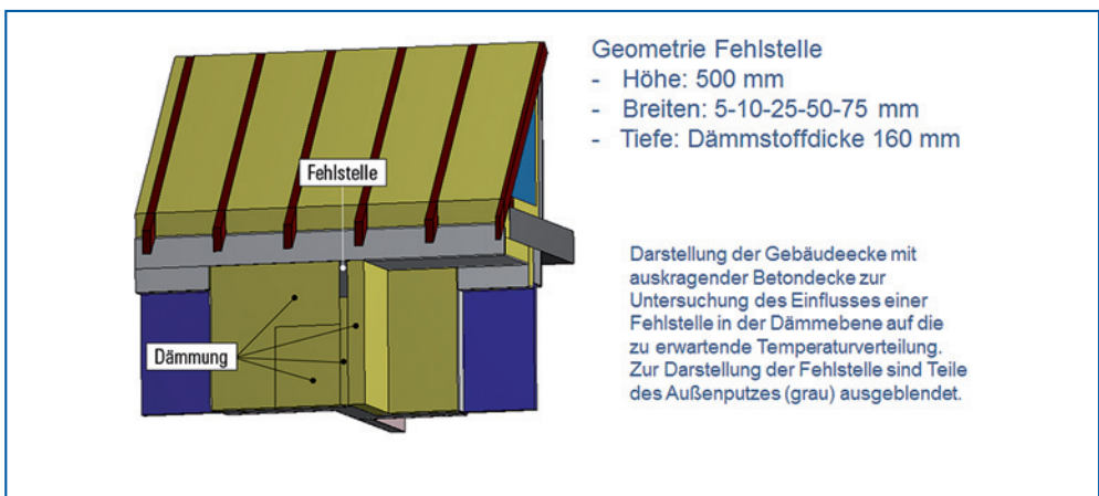
Abbildung 5-5 Außenansicht des FE-Modells mit Lage einer angenommenen Fehlstelle in der Ebene des Wärmedämmverbund-Systems (Programmsystem Ansys-Workbench)
