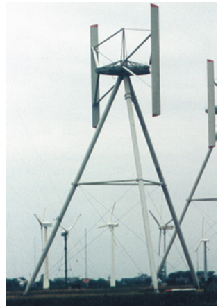
■ Abb. 38: Zweiblatt-H-Darrieus-Turbinen. Links: Generator am Boden und rechts: mit Generator am Anlagenkopf
