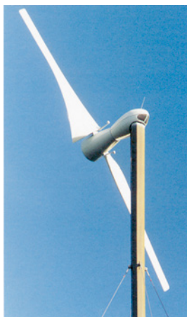
■ Abb. 62: Passive Nachführung durch Leeläufer
