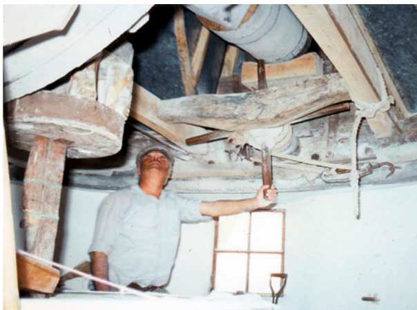
■ Abb. 18: Turmkopfdrehung zur Leistungsbegrenzung
