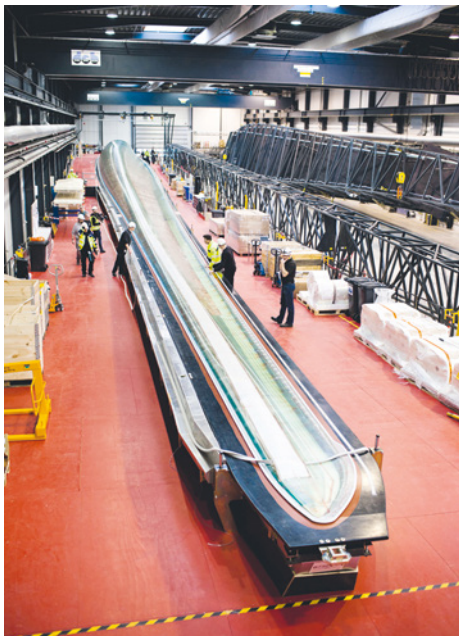
■ Abb. 47: Rotorblatt-Fertigung mit Verbundwerkstoffen
