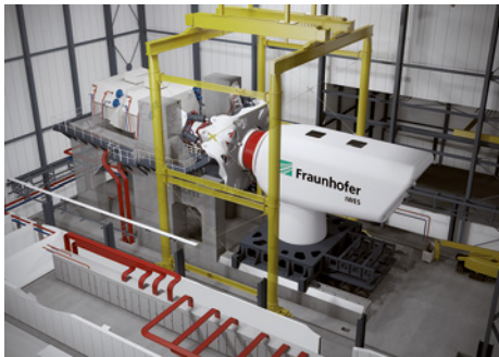
■ Abb. 95: Im Prüfzentrum DyNaLab kommen komplette Gondeln der Multi-Megawattklasse auf den Prüfstand.
