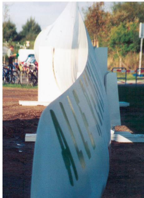
■ Abb. 48: Vorgebogenes Rotorblatt (Nordex N 117/117 m Rotordurchmesser)
