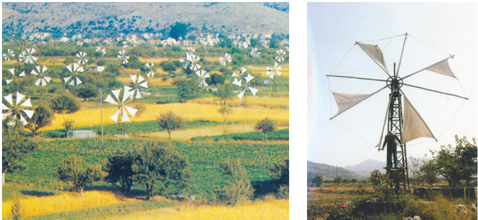
■ Abb. 16: a) Segelwindmühlen zum Wasserpumpen auf der Lassithi-Ebene auf Kreta, b) Reffen der Segel zur Leistungsbegrenzung
