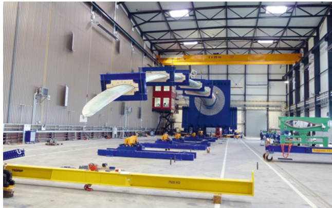
■ Abb. 94: Im Kompetenzzentrum Rotorblatt in Bremerhaven werden Rotorblätter bis zu 90 m Länge mechanisch getestet.
