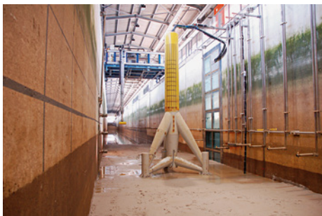
■ Abb. 92: Im Rahmen der RAVE-Forschungen zu Gründungsbauwerken wird ein Modell eines Tripod-Fundaments im großen Wellenkanal an der Universität Hannover getestet.
