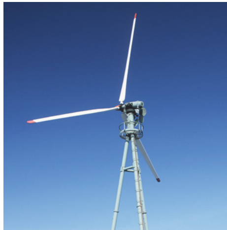
Abb. 23: Allgaier-Anlage, 6 bzw. 10 kW Nennleistung 10 m Rotordurchmesser
