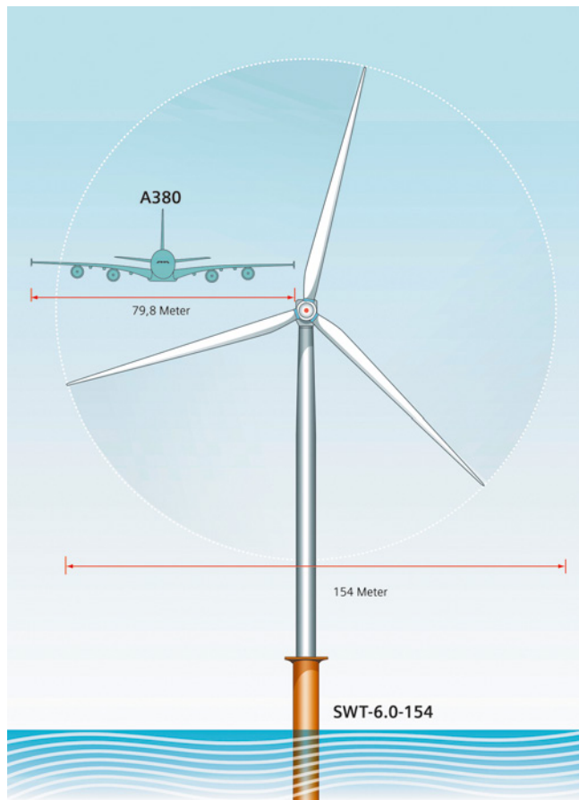
■ Abb. 2: Größenvergleich: 6-MW-Turbine – Großraum- flugzeug A 380
