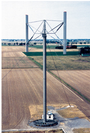
■ Abb. 38: Zweiblatt-H-Darrieus-Turbinen. Links: Generator am Boden und rechts: mit Generator am Anlagenkopf
