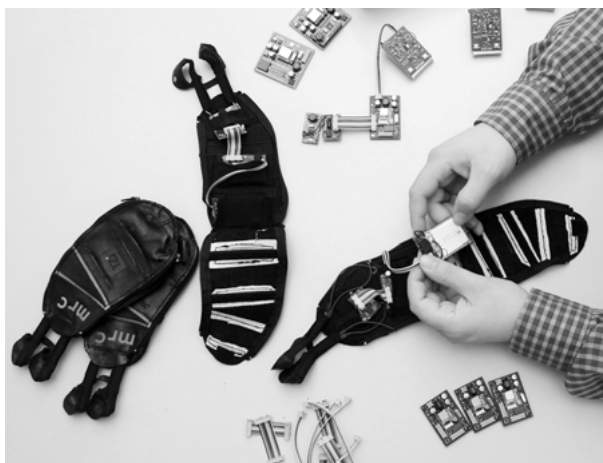
Abb. 7: Komponenten des optimierten Winspect-Eingabehandschuhs, 3. Generation (Bild: MRC)
