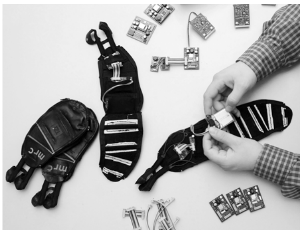
Abb. 7: Komponenten des optimierten Winspect-Eingabehandschuhs, 3. Generation (Bild: MRC)
