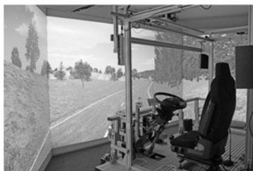
Bild 1: Links: statischer Lkw-Fahrsimulator; rechts: Wizard-of-Oz Versuchssetting
