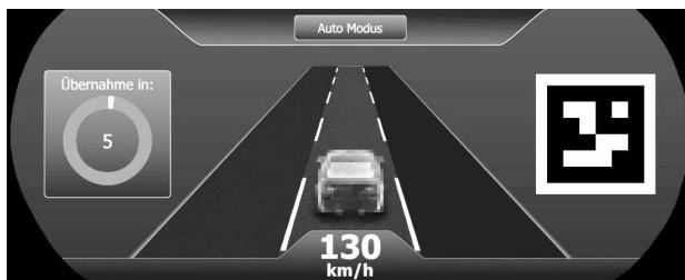
Bild 2: Das HMI im Instrument Cluster im automatischen Modus mit Übernahmeaufforderung und Marker für das Eyetracking System.
