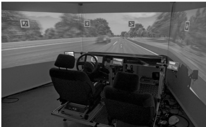
Bild 1: Konfiguration der Sitzkiste und des Simulator-Raums (Foto: Matthias Powelleit).
