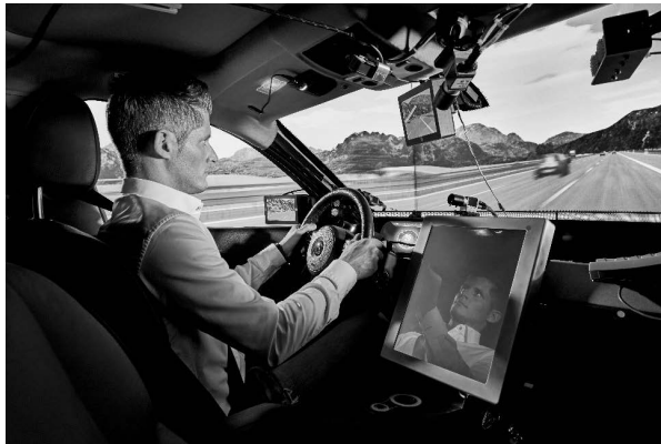
Bild 1: Versuchsperson im Continental-Fahrsimulator während manuellen Fahrens.
