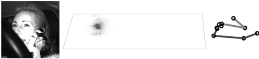
Bild 8: Blickmuster während eines Telefonats (grüner Punkt auf der Windschutzscheibe) ähneln den Blickverteilungsmustern während manueller Fahrt ohne Nebentätigkeit (graue Punktwolke). Eine 3D-Skelettmodell (rechts, Blickwinkel vom Rückspiegel im Dachhimmel. Linker Arm rot, rechter Arm blau dargestellt) kann über die Auswertung der Position von Körpergelenken helfen, fahrfremde Tätigkeiten zu erkennen.
