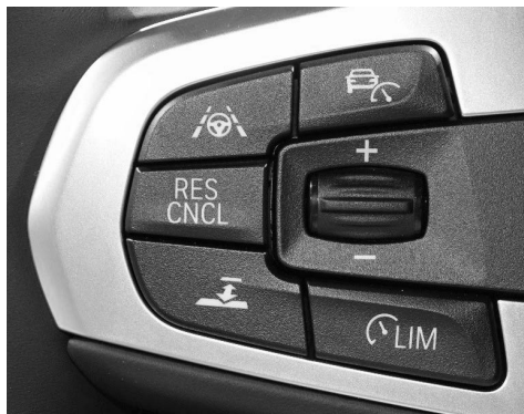
Bild 2: Bedienelement für ein SAE Level 2 System.
