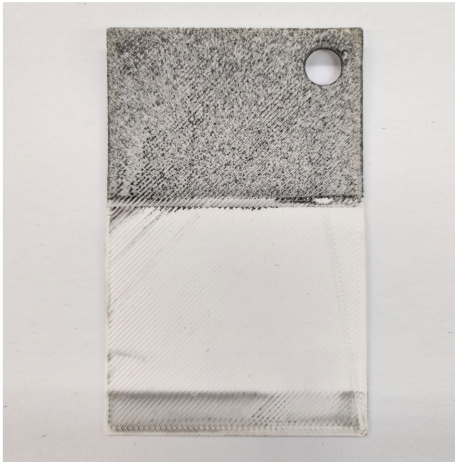
Bild 2. Testmaskierung oben gestrahlt und im Lichtbogenverfahren beschichtet. Grafik: HS Aalen
