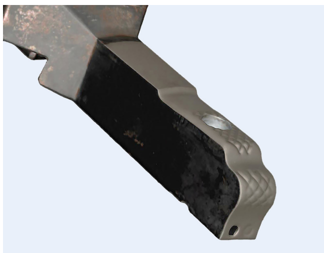
Bild 6. Beschichtetes Werkstück mit hoher Kantenqualität. Foto: HS Aalen
