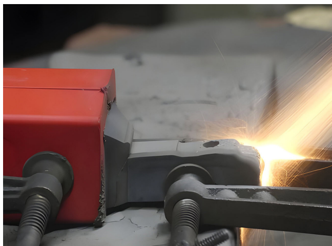
Bild 5. HVOF-Beschichtungsversuch mit additiv gefertigten Maskierungen. Foto: HS Aalen
