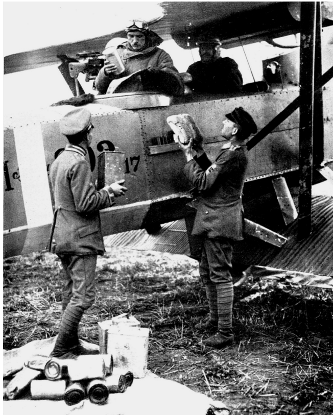
Abb. 3: Infanterieflieger als Versorger abgeschnittener Einheiten: Eine Junkers J4 wird mit Brot und Konserven beladen. Die Wellblechbeplankung der unteren Tragfläche ist gut zu erkennen. Quelle: Peter Supf, Das Buch der deutschen Fluggeschichte, Bd. 2: Vorkriegszeit, Kriegszeit, Nachkriegszeit bis 1932, Stuttgart 1958, S. 307.
