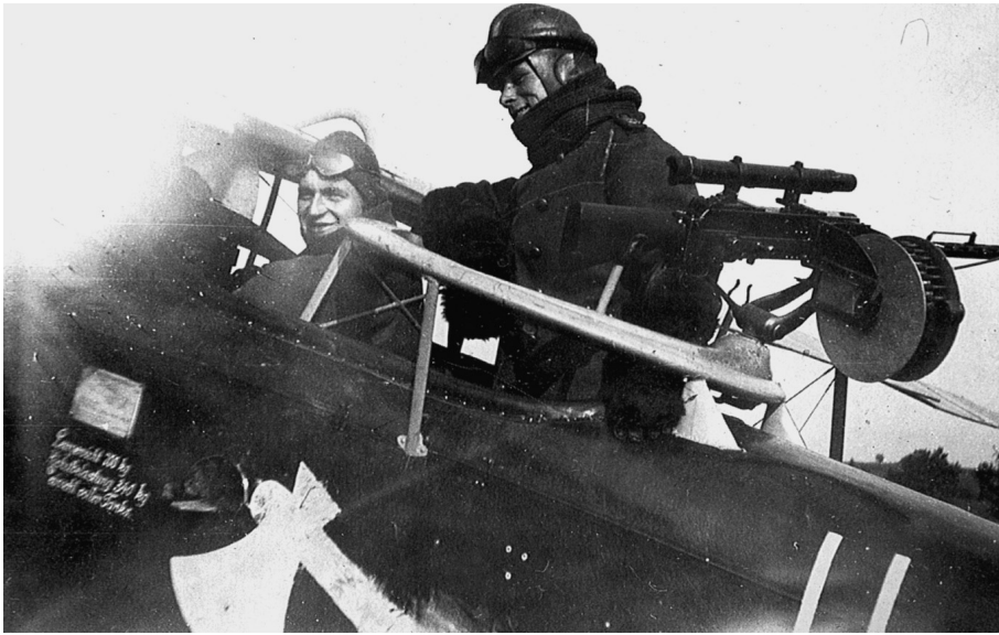
Abb. 6: Die Besatzung und die Hauptwaffe: Fliegerschützen-Maschinengewehr auf Tiefangriffslafette. Quelle: Peter M. Grosz, Halberstadt CI.IV (Windsock Datafile, Bd. 43), Berkhamsted 1994, S. 6.
