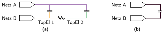
Abbildung 6.33: a: Ersatzschaltplan, wie ihn die Elektrostatik-Analyse aus der Chip-Geometrie aus Abb. 6.32 extrahieren würde. b: Ersatzschaltplan der Messung, wenn die Kontaktfläche des Netzes A und eine beliebige Kontaktfläche des Netzes B bei einer Messung kontaktiert werden würde.
