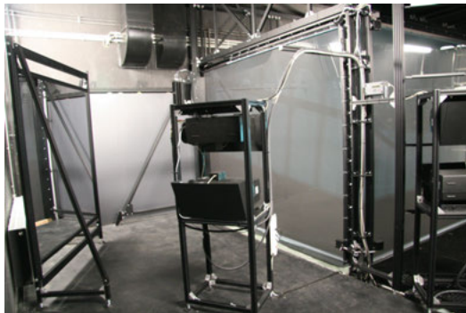
Abbildung 4: Aluminium-Tragkonstruktion der CAVE
