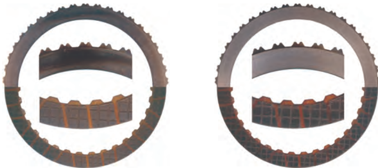
Bild 7: Fotos der vorgeschädigten Stahl- und Belaglamellen - a) nach Laststufe 6, b) nach dem Dauerschaltversuch
