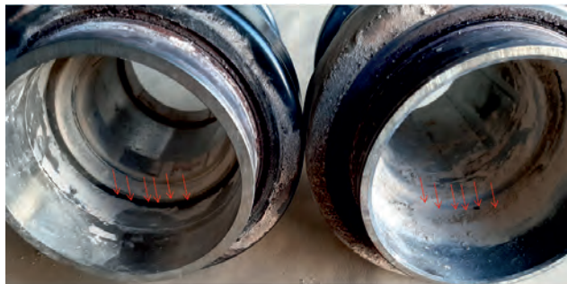
Bild 3: Schmutzablagerung in weiterentwickeltem KAS - (links im Bild) . konventionellem NKW-Ausrücklager (rechts im Bild)
