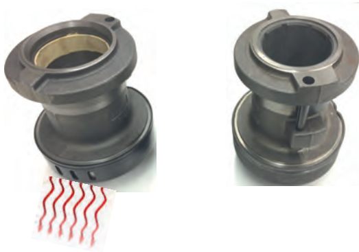
Bild 3: Wärmeabfuhr bei weiterentwickeltem KAS-(links). Konventionellem NKW-Ausrücklager(rechts)
