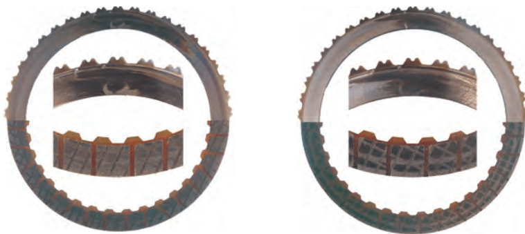
Bild 9: Fotos der vorgeschädigten Stahl- und Belaglamellen - a) nach Laststufe 7, b) nach dem Dauerschaltversuch
