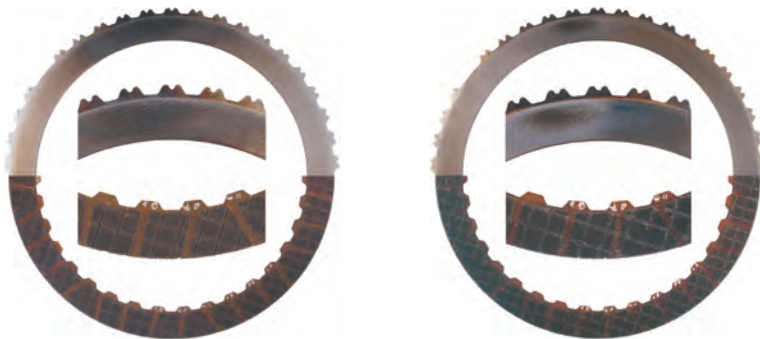
Bild 5: Fotos der vorgeschädigten Stahl- und Belaglamellen - a) nach Laststufe 4, b) nach dem Dauerschaltversuch
