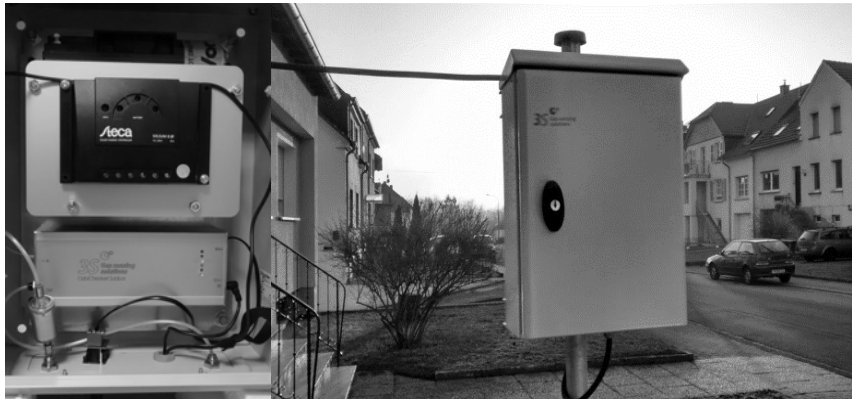
Bild 1: Sensorsystem für das Pilotprojekt Immissionsmessung. Links: Innenaufbau mit Messsystem (unten), Zuleitung (links mit Gewebefilter) und Abluft (rechts) sowie Stromversorgung (oben).
