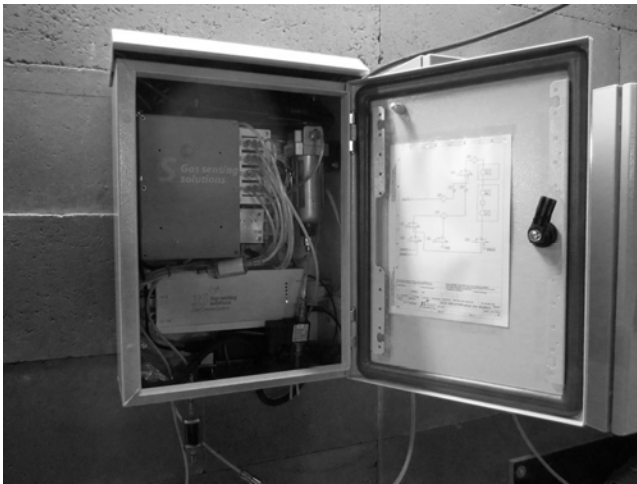
Bild 3: Sensorsystem zur Messung der Gerüche an einer nasschemischen Luftreinigungsanlage.
