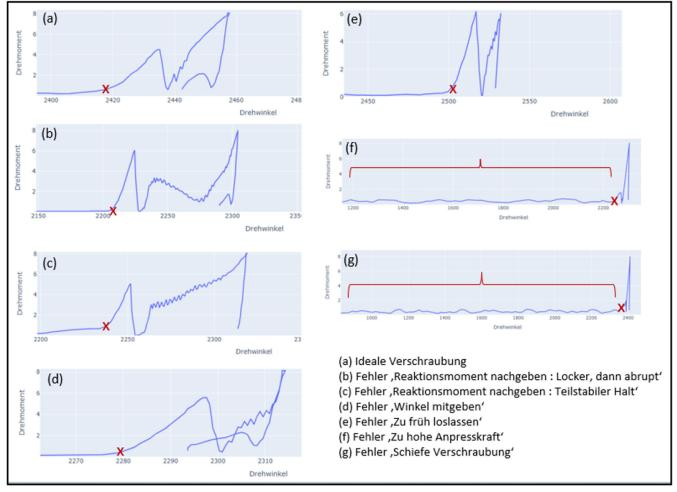
Bild 5. Drehmoment-Drehwinkel-Kurven für fehlerhafte Schraubungen. Grafik: Fraunhofer IAO
