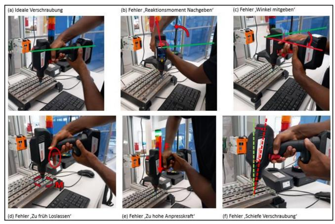
Bild 4. Durchführung einer gezielt fehlerbehafteten Messreihe. Fotos: Fraunhofer IAO
