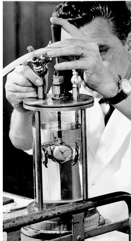
Abb. 4a: Kontrollapparat für die Dichtigkeit der Uhren. Quelle: © Tissot SA, Le Locle.
