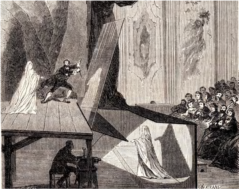
Abb. 1: Zum Funktionsprinzip des Bühnentricks Pepper's Ghost von 1862, Le Monde Illustré . 30
