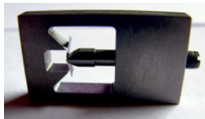
Bild 4.28: Biegevorrichtung für die Hochtemperaturversuche
