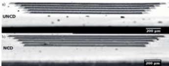
Bild 4.27: REM Aufnahmen der doppelseitig eingespannten Balken. Nachgedruckt aus M. Mohr et al., Journal of Applied Physics , 116, 124308, 2014 mit freundlicher Genehmigung von AIP Publishing.
