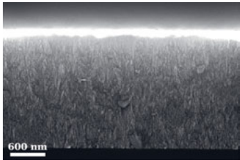
(a) Repräsentative REM Aufnahme des Querbruchs einer untersuchten Schicht. Es ist keine Änderung der Filmmorphologie über die betrachtete Filmdicke zu erkennen.
