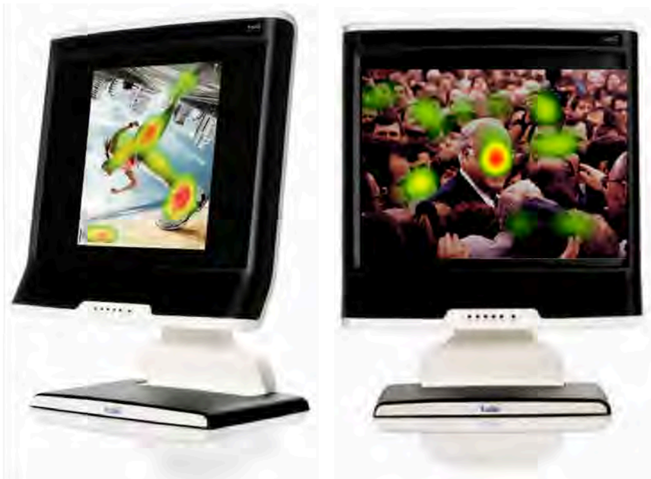
Abbildung 8: Stationärer Tablemounted Eyetracker T120 der Firma Tobii (Quelle: Tobii Technologies; Original für eigene Darstellung bearbeitet)
