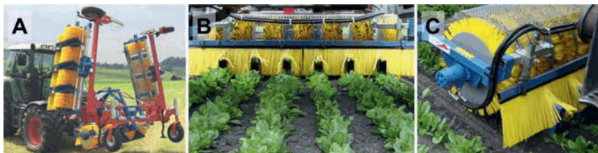
Bild 1.8: Reihenhackbürste in Transport- (A) und Arbeitsposition (B)(C) (BAERTSCHI 2014)
