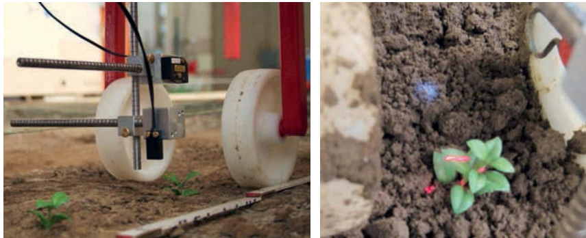
Bild 2.13: Sensorträger mit einem Farb- und Laser-Distanzsensor zur Detektion der Pflanzen in der Reihe (links); Reflexionen des Farbsensors (blau) sowie des Laser-Distanzsensors (rot) (rechts)
