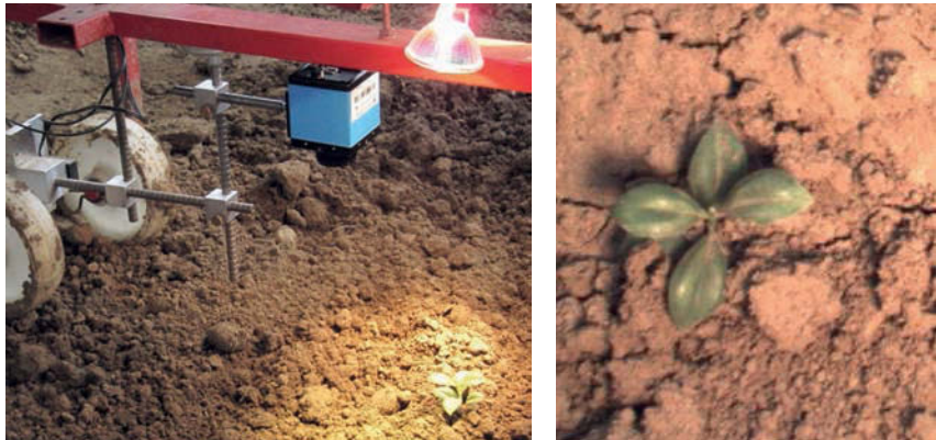
Bild 4.3: Bilderfassung mit einer CCD-Kamera auf der Bodenrinne (links); Aufnahmeperspektive der Kamera mit Pflanzendummy im Bildausschnitt (rechts)
