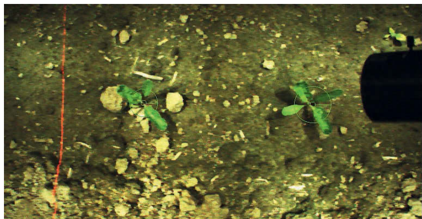
Bild 5.38: Pflanzenerkennung mit einer Farbkamera bei gleichzeitigem Laser-Lichtschnittverfahren zur Profilabtastung
