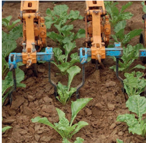
Bild 1.7: Werkzeuge eines Anbaugerätes für das Hacken zwischen den Pflanzenreihen
