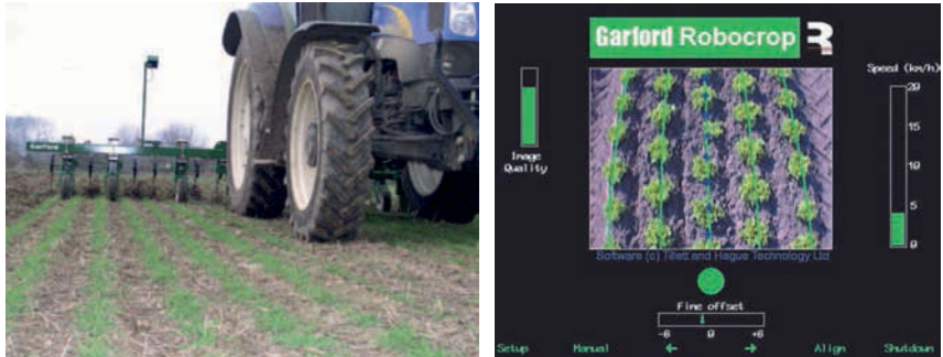
Bild 1.9: Kamera-gesteuerte Reihenhacke (links) mit einer Beispielansicht des Kontrollterminals in der Traktorkabine (rechts) (GARFORD 2011)
