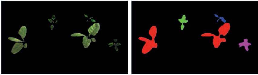
Bild 4.33: Original-Farbbild mit überblendeter Maske aus dem IR-basierten Binärbild (links); farblich markierte Pflanzen nach Dilatations- und Erosionsberechnungen (rechts)
