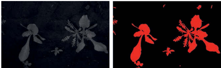
Bild 4.21: Infrarotaufnahme (links) mit dem über das Schwellwertverfahren errechneten Binärbild (rechts)
