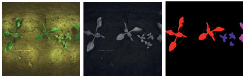
Bild 5.30: Original-Farbbild (links); Original-NIR-Bild (Mitte); aus den Originalbildern errechnetes Binärbild mit zwei erkannten und rot markierten Zuckerrüben (rechts)
