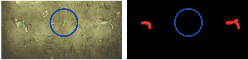
Bild 5.15: Original-Farbbild (links) und daraus errechnetes Binärbild (rechts) mit nicht erkannter Zuckerrübe (blau markiert), die bereits Keimblätter, aber keine sichtbaren Laubblätter aufweist
