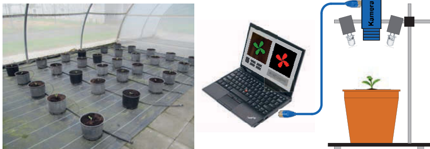
Bild 4.48: Pflanztopfversuche unter einem Wetterschutzdach (links), Versuchsaufbau mit Pflanze, Beleuchtung, CCD-Kamera und Notebook zur Bildakquisition (rechts)
