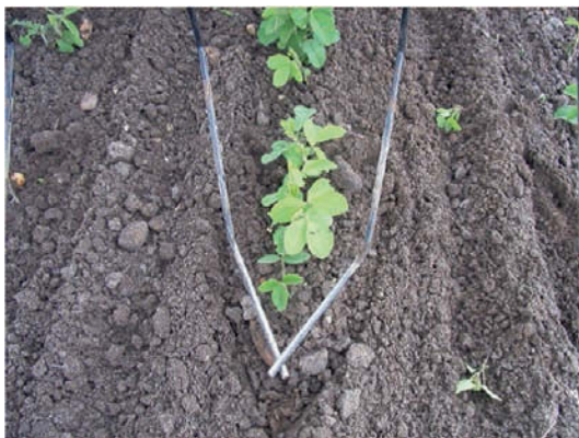
Bild 2.1: Zwei federnde Werkzeuge einer Torsionshacke im Einsatz (MÜCKE 2012)
