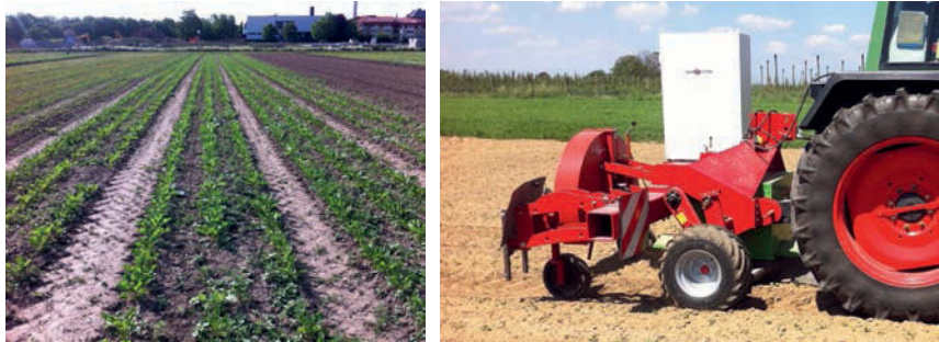
Bild 4.50: Versuchsfläche mit dreireihigen Parzellen (links), Versuchsaufbau zur Bildaufnahme während der Fahrt (rechts)
