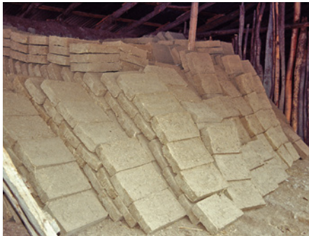
Bild 2.41 Traditionelle Herstellung von Lehmsteinen in einem kleinen Betrieb in Chile: Mauken (links oben), Formen (rechts oben) und Trocknen (links).
