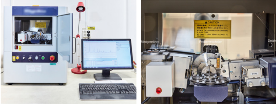
Bild 8.21 Ein modernes Röntgendiffraktometer (links). Die drei Grundeinheiten Röntgenröhre, Probe und Detektor (rechts). Die Probe und der Detektor sind in einem Goniometer eingebaut, welches beide in einem definierten Bereich von Beugungswinkeln bewegt.
