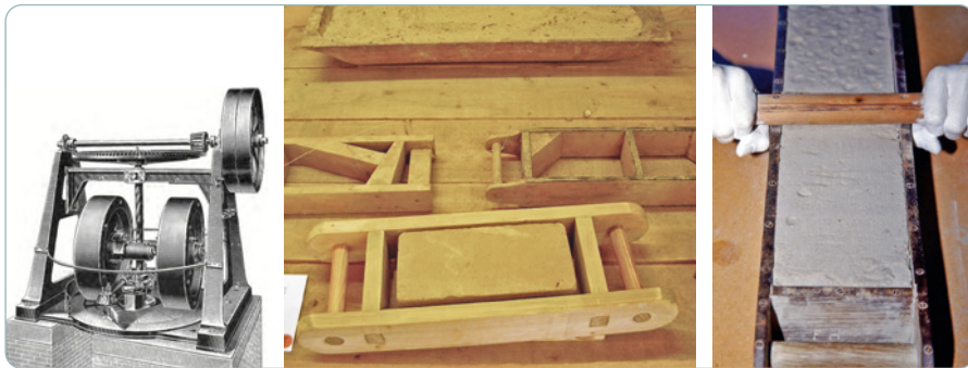
Bild 2.32 Herstellung von Ziegelprodukten: Kollern und Mauken des Rohlehms (links), sowie Formgebung im Handstrichverfahren (Mitte und rechtes Bild).
