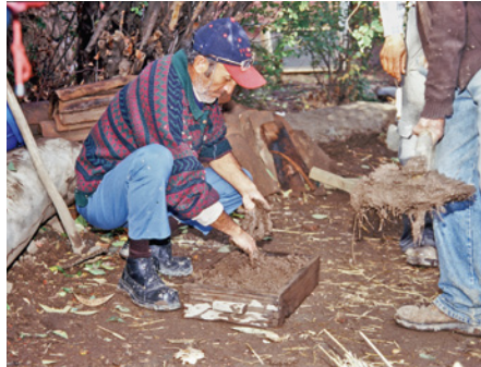
Bild 2.41 Traditionelle Herstellung von Lehmsteinen in einem kleinen Betrieb in Chile: Mauken (links oben), Formen (rechts oben) und Trocknen (links).
