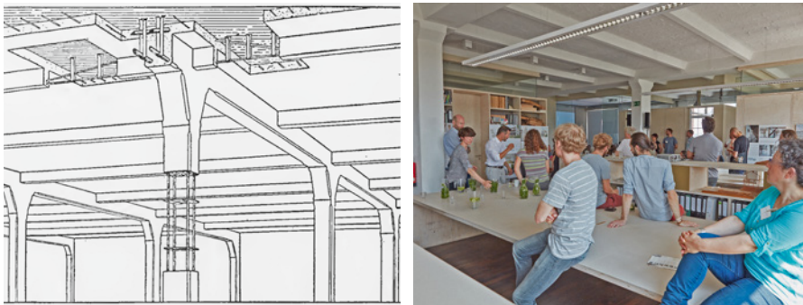
Bild 4.6 Links – System Hennebique (Quelle: [4.23]). Betontragrahmen in einem Gewerbegebäude aus dem 19. Jahrhundert (rechts)
