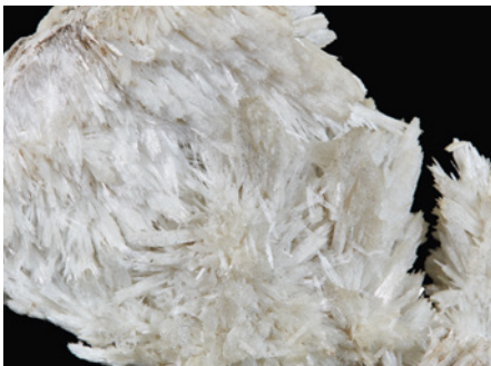
Bild 7.3 Faserige Morphologie des Minerals Tremolit. Bei Tremolit handelt es sich um einen Amphibolasbest.
