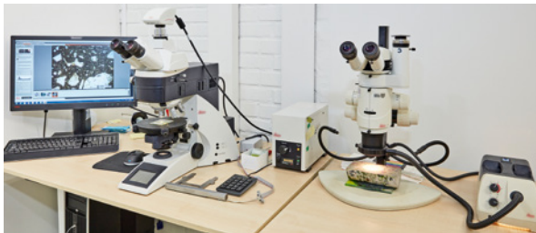
Bild 8.4 Typischer Mikroskopiarbeitsplatz. Rechts neben dem Polarisationsmikroskop befindet sich eine Probenhalterung für die Punktzählung zur quantitativen Bestimmung von Mineralanteilen.
