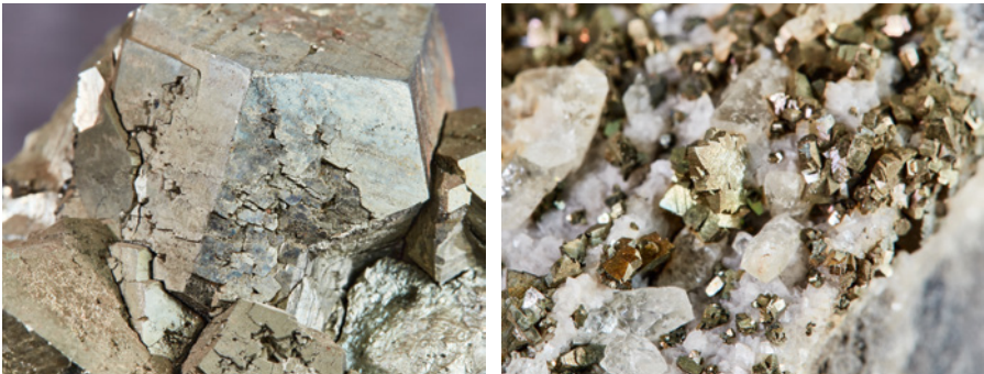
Bild 8.1 Ein Beispiel für polymorphe Phasen (gleiche chemische Zusammensetzung bei unterschiedlicher Kristallstruktur): Eisensulfid ( \text{FeS}_2 ) in der Form von Pyrit (links) und Markasit (rechts).
