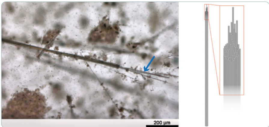
Bild 7.4 Chrysotilasbest, der an den Faserenden in weitere feinere Fasern aufspießt (links, blauer Pfeil; Mikroskopbild, Durchlicht). Das rechte Bild zeigt schematisch, dass eine Asbestfaser aus unzähligen dünneren Fasern zusammengesetzt ist.
