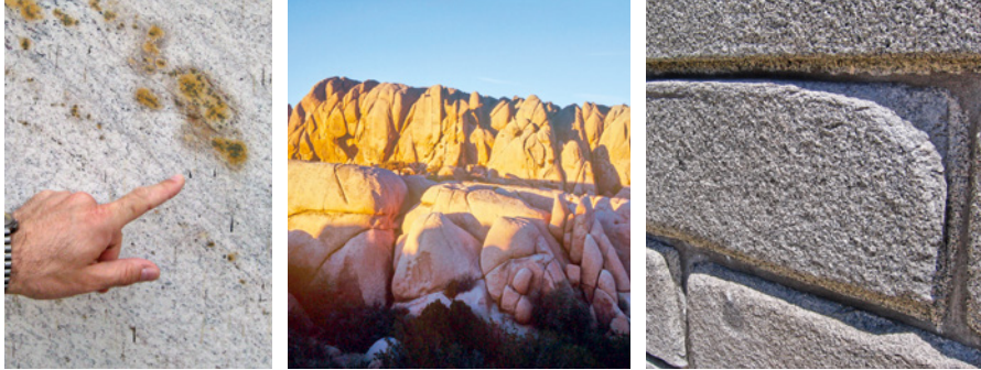
Bild 2.16 Rostartige Verfärbungen einer Granitfassadenplatte hervorgerufen durch Pyrit-einschlüsse (links). Typische Wollsackverwitterung eines Granitkomplexes (Mitte) und eine wollsackähnliche Verwitterung eines Granitsteins in einer Gebäudefassade (rechts).
