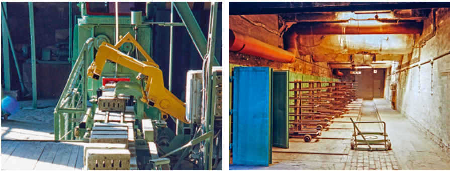
Bild 2.33 Herstellung von Ziegelprodukten: Formgebung mit Strangpresse und Schneiden des Strangs mittels Drahtmesser (links). Trocknen der Grünlinge in Trocknungskammern (rechts). Ziegelpark Mildenberg bei Berlin.
