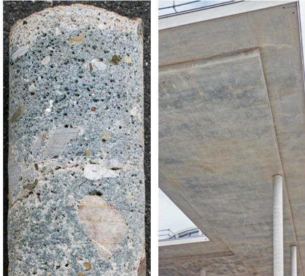
Bild 4.11 Bohrkern eines hochofenzementhaltigen Betons (links). Typisch graubläuliche Sichtflächen von Beton mit Hüttensand (rechts).
