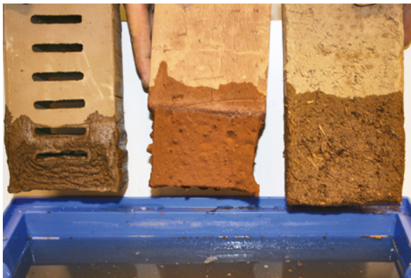
Bild 2.48 Verhalten von verschiedenen Lehmsteinen in Kontakt mit Wasser (Tauchprüfung in Wasser für fünf Minuten): bleibende Quellverformung (linker Stein), Absanden (Mitte), keine Schäden (rechts).
