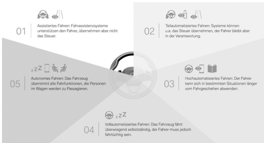
Abbildung 5: 5 Stufen des automatisierten Fahrens,
