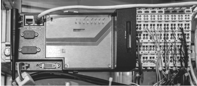
Abbildung 7.1.: WAGO 758-875 IPC eingebaut in einem Modul der Anlage M4P.AC.
