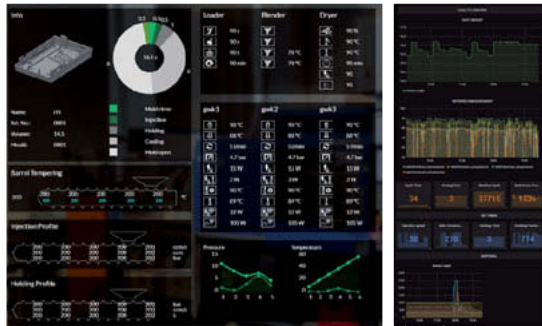
Bild 5: Live Visualisierung des Prozesszustandes und der Qualitätsgrößen
