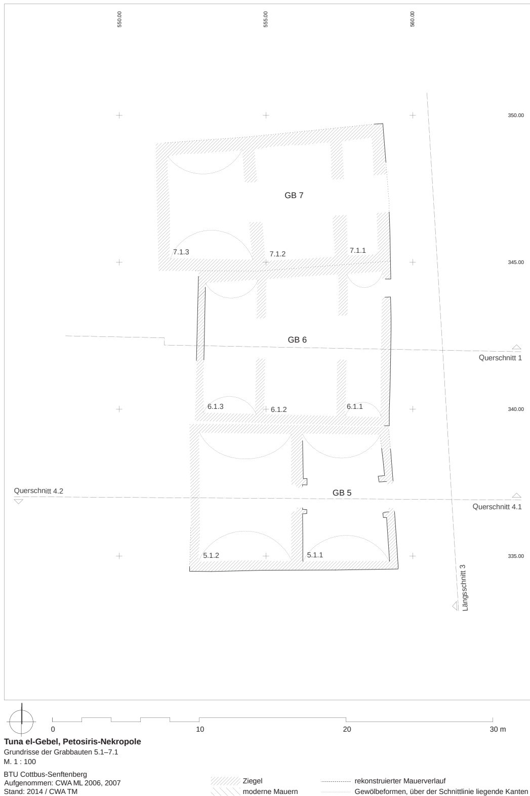
Abb. 3: Grundrisse von GB 5.1–7.1, Rekonstruktionsvorschlag; 2014
