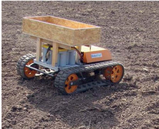
Bild 2: Roboterplattform mit Ladeplattform für Behälter
