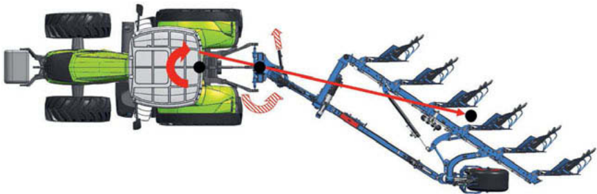
Bild 4: Kompensation des Seitenzuges durch Stellglied auf Deichsel
