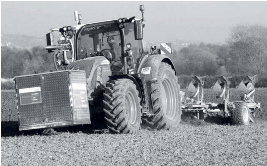
Bild 2: Fendt Vario 724 S4 beim Pflügen mit portabler Emissionsmesstechnik (PEMS)
