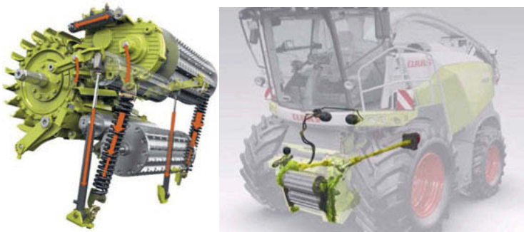
Bild 1: Hydraulische Vorpressung mit Zugzylindern im CLAAS JAGUAR
