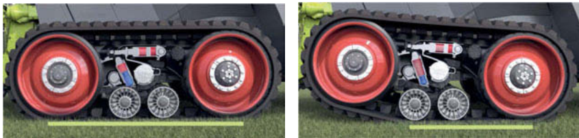
Bild 5: Aufstandslänge des Raupenlaufwerks bei Geradeausfahrt (links) und bei Kurvenfahrt (rechts) auf Grünland.
