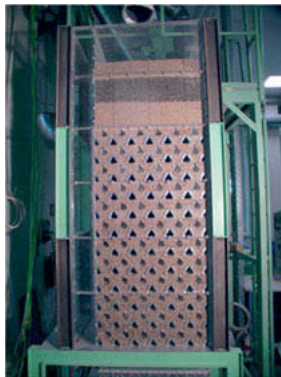
Bild 1: Geometrie des Versuchstrockners zur verfahrenstechnischen Analyse des Partikelflusses, der Luftströmung und des Trocknungsprozesses
