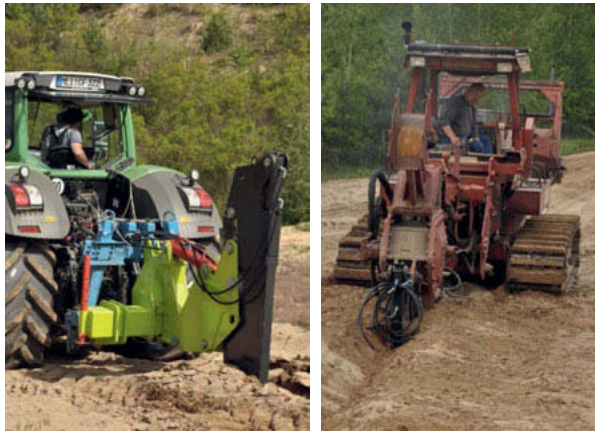
Bild 5: Traktor und Raupenbasierte Werkzeugerprobung auf Sand -Kippenboden
