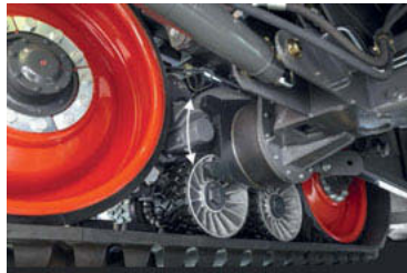
Bild 4: Pendelanschlag zur erleichterten Bergung in extremen Bedingungen
