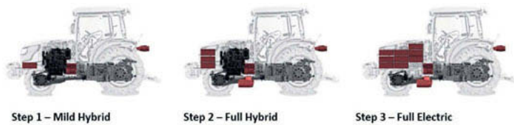
Bild 2: Die drei Vorstufen zu einer integrierten vollelektrischen Fahrzeuglösung
