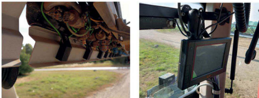
Bild 8: Anbringung der SprayRay Sensoren und des MSO SprayMon Bordcomputers
