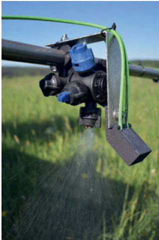
Bild 1: gekapseltes CW Radarmodul, angeordnet am Sprüh
