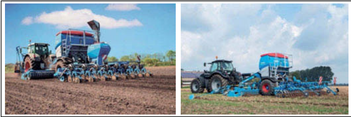
Bild 1: Kombinationsvarianten Solitair 25 (links mit Azurit; rechts mit Särschiene)
