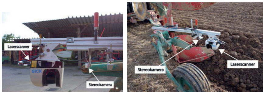
Bild 2 a) und b): Laserscanner und Stereokamera auf Aluprofilschienen am Pflug befestigt
