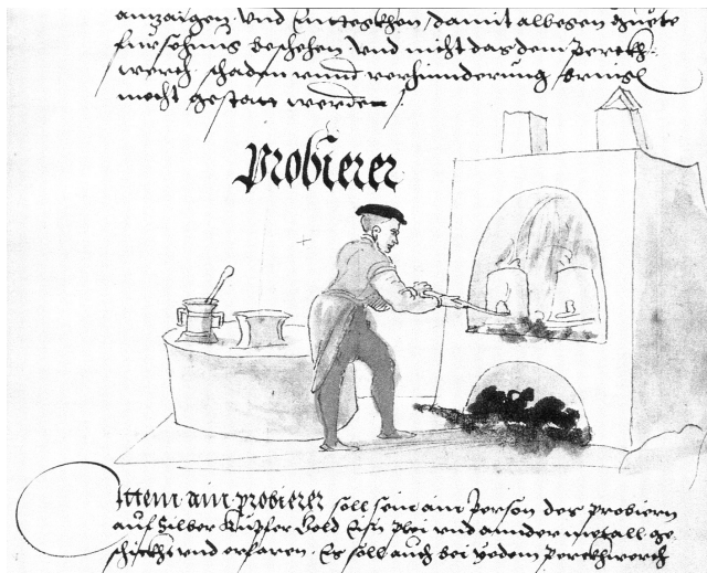
Abb. 4: Ein Probierer bei seiner Arbeit am rechteckigen Probierofen: „Item ain Probierer soll sein ain Person des Probieren auf Silber, Kupfer, Gold, Eysn, Plei und annder Metall geschickt und erfaren.“ Quelle: Schwazer Bergbuch 1554, Bd. II, Bochum 2006, S. 117.
