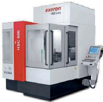
Bild 2-9: Versuchsmaschinen DIGMA Exeron HSC 600 und HERMLE UWF1202H (Quelle: Exeron und IfW/Hermle)
