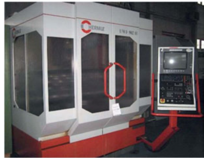
Bild 2-9: Versuchsmaschinen DIGMA Exeron HSC 600 und HERMLE UWF1202H (Quelle: Exeron und IfW/Hermle)
