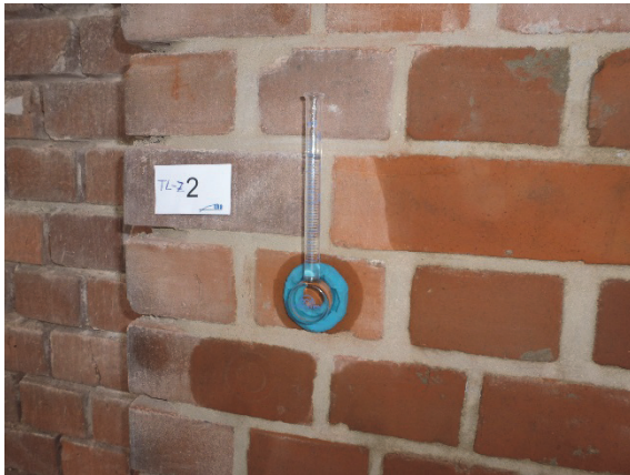
Bild 14 Hohe Wasseraufnahme der Fassade
