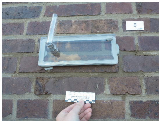
Bild 8 Untersuchung der Wasseraufnahme mit der WA-Platte nach Franke
