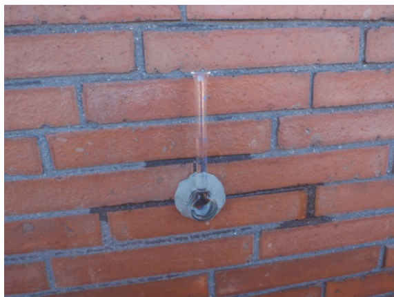
Bild 7 Untersuchung der Wasseraufnahme mit dem Karsten'sches Prüfröhrchen (hier an einer Fuge)
