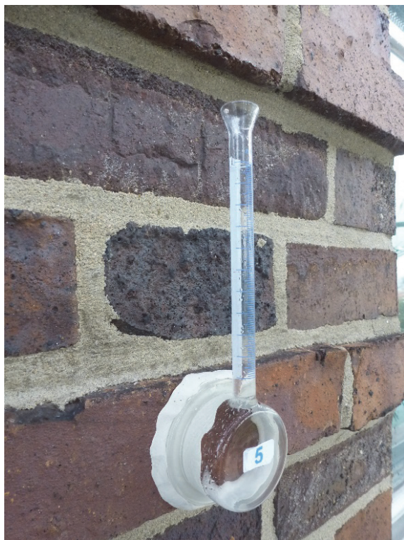
Bild 6 Untersuchung der Wasseraufnahme mit dem Karsten'sches Prüfröhrchen (hier an einem Ziegel)
