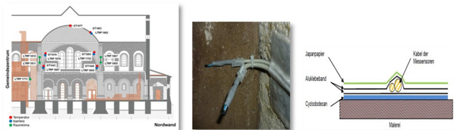
Bild 2 links: Exemplarische Darstellung der Messstellen unmittelbar an der Nordwand mitte: Aufnahme eines Sensorpaares (Oberflächentemperatur und Nahfeldklima aus Temperatur und relativer Feuchte) rechts: Befestigung der Oberflächentempersensoren mit Cyclododecan
