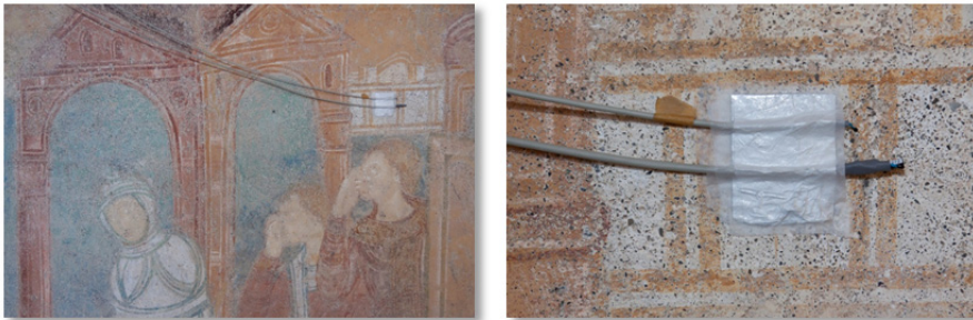
Bild 2 links: Messsonden zur Erfassung von Oberflächen- und Nahfeldklimate in der Bildszene der Erweckung des Lazarus in St. Georg auf der Insel Reichenau rechts: Detailaufnahme der Messsonden (Januar 2012, Foto Dörthe Jakobs)
