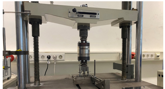
Bild 2. Prüfstand zur Ermittlung der Spaltzugfestigkeit. Foto: IFUM
