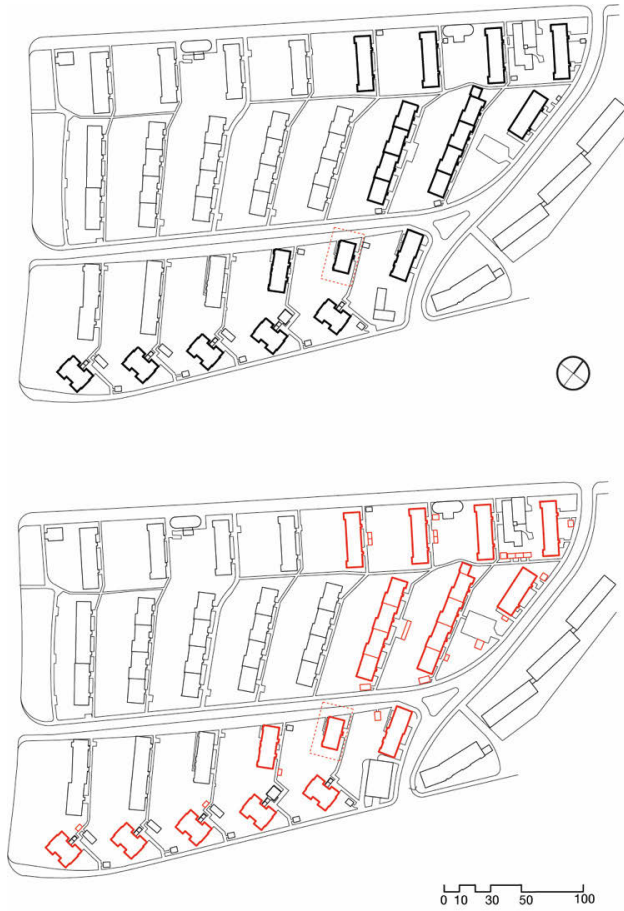
Abb. 8: Lagepläne Bestand – Nachverdichtung, Fritz-Kissel-Siedlung
