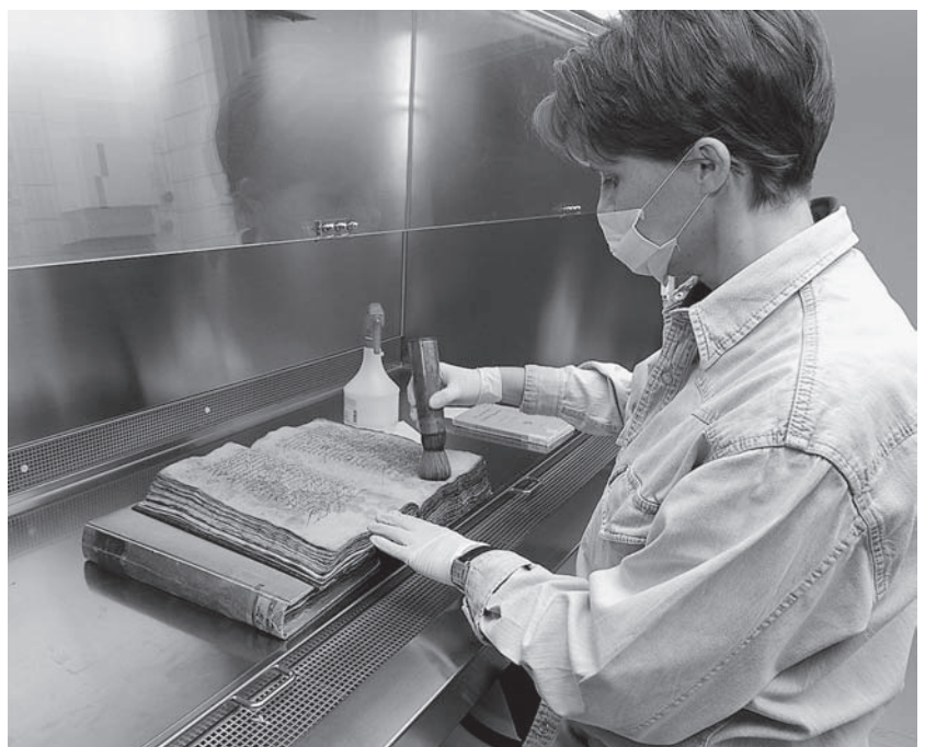
Reinigung eines mikrobiologisch kontaminierten Bandes in einer Sicherheitswerkbank (Foto: SLUB Dresden, Rous)
