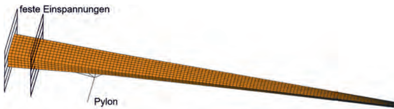
Bild 5: Darstellung des ungedämpften FE-Modells der Wingbox [4]
