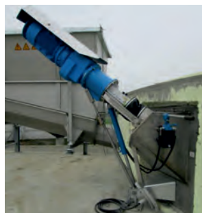
b) Rührwerk für Biogasanlagen (Quelle: http://www.rema-maschinenbau.de/ )
