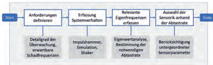
Bild 1: Methodik zur Auswahl von Sensorik zur schwingungsbasierten Zustandsüberwachung auf Basis der Abtastrate
