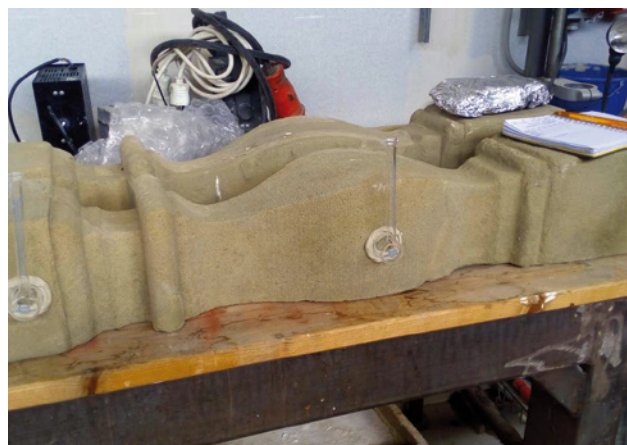
Abb. 2 Reinigungsversuche an einer ausgebauten Balustrade der Kirche Neuenstein mittels chemischen Reinigern und Dampfsauger in der Aedis-Werkstatt. Test der Wasseraufnahme mit Karstensen Prüfröhrchen nach der Reinigung
