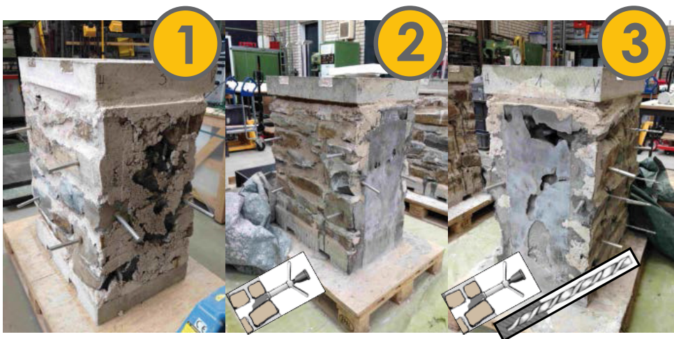
Abb. 13 Mauerwerkprüfwände (Zweischalenkonstruktion mit mittlerer Verfüllung) aus Mayschoss-Grauwacke aufgemauert (1), zusätzlich injiziert (2) und injiziert und vernastet (3)
