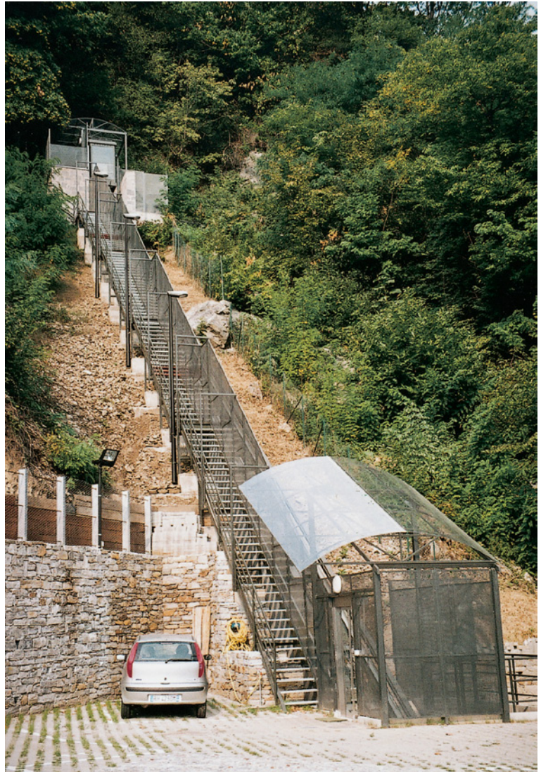
Abb. 5-8: Ausbildung eines Schrägaufzugs mit seitlich angeordneter Treppe zur Erschließung einer Wohnanlage in bergiger Umgebung als technische Erschließungslösung
