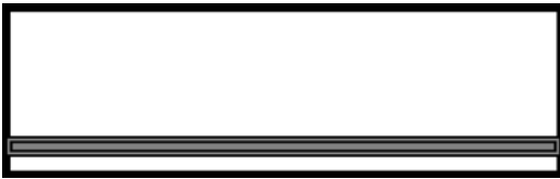
Abb. 6-4: Stufe mit aufgeklebtem Sicherheitsstreifen kontrastreich abgesetzt.
