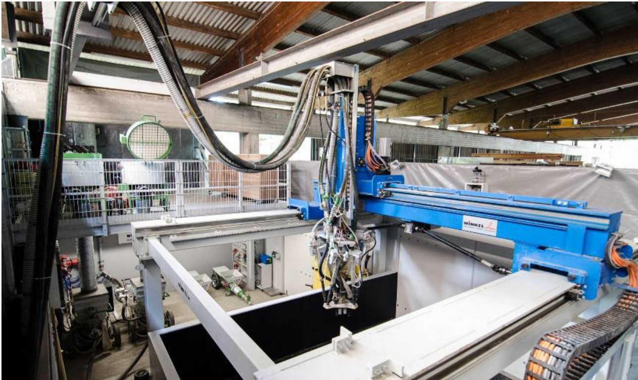
Abb. 64: Applikationssystem mit Stewart-Gough-Plattform © ILEK 528
