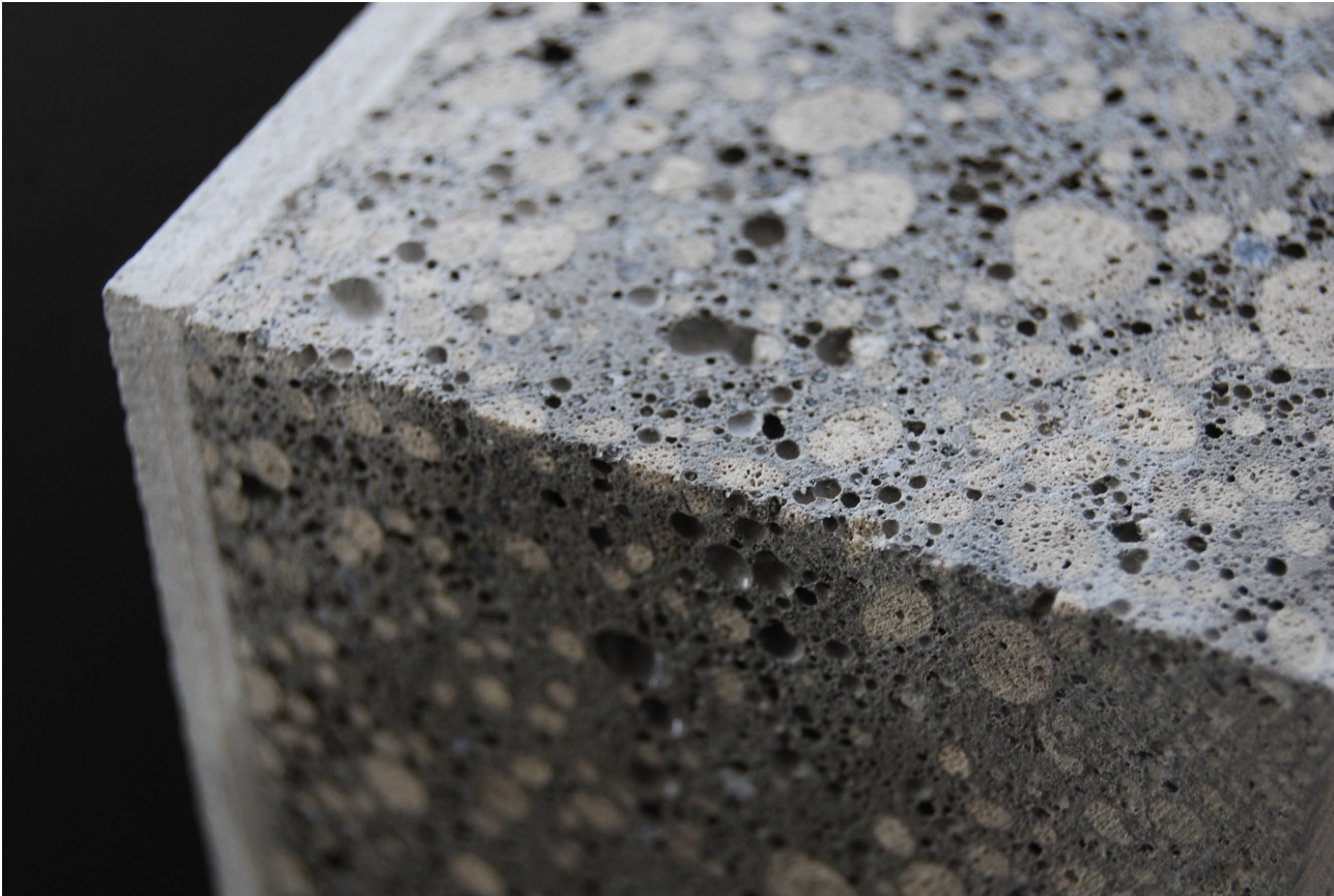
Abb. 75: Hybridbeton-Elemente mit UHPC-Deckschicht und Aerogel-Schaumbeton © G.tecz Enineering GmbH
