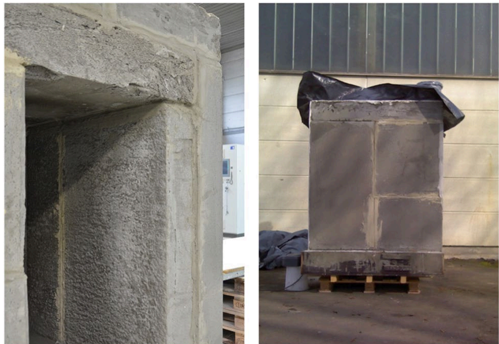
Abb. 84: Demonstrator zum Langzeit-Monitoring der Bauphysik, Statik und Verbindungstechnik © TU Dortmund, Lehrstuhl Baukonstruktion. Eigene Darstellung
