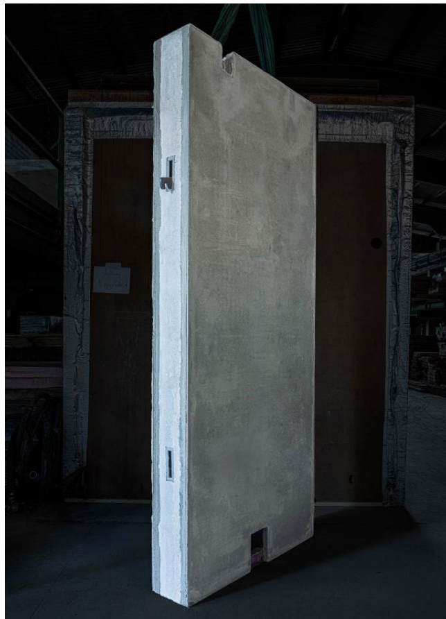
Abb. 72: Demonstrator der Gradientenbetonwand © ILEK
